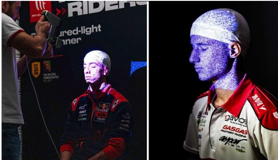
Εικόνα 8: Λήψη μετρήσεων της κεφαλής επαγγελματία οδηγού αγώνων με χρήση σαρωτή laser για τη δημιουργία εξατομικευμένου κράνους
