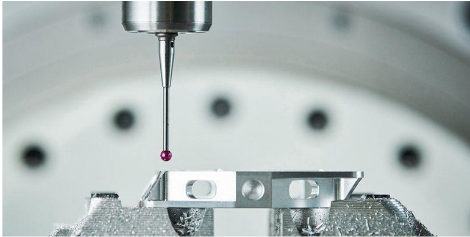
Εικόνα 10: Μέθοδος επαφής για τη λήψη μετρήσεων
