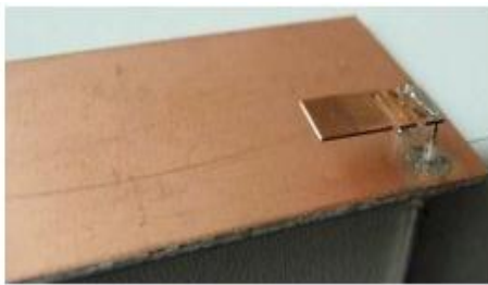
Σχήμα 2.17: Κεραία PIFA τύπου μαιάνδρου [11]
