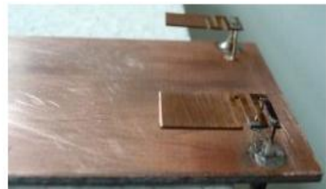
Σχήμα 2.17: Κεραία PIFA τύπου μαιάνδρου [11]
