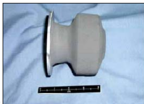
Σχήμα 1.38: α) Πτερύγιο από Ti6Al4V που ψεκάστηκε σε κύλινδρο από αλουμίνιο με διάμετρο 50 mm και β) συμμετρικό σχήμα από Ti6Al4V που ψεκάστηκε σε επίπεδο υπόστρωμα αλουμινίου πάχους 3 mm [Blose 2005b].
