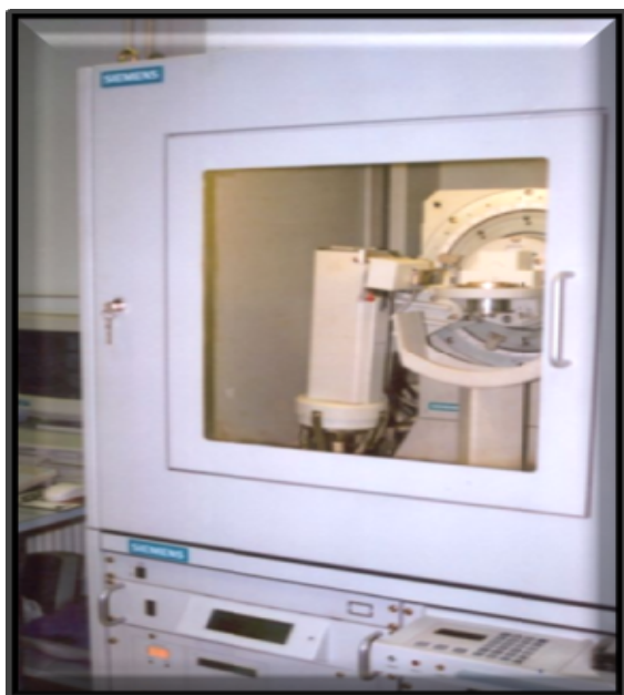
α) Η συσκευή ανάλυσης με περίθλαση ακτίνων X (X-Ray Diffractometer D5000 Siemens) της Σχολής Χημικών Μηχανικών του Ε.Μ.Π και β) ο φούρνος (Thermawatt) του Εργαστηρίου Ναυπηγικής Τεχνολογίας της Σχολής Ναυπηγών Μηχανολόγων Μηχανικών για την πραγματοποίηση των θερμικών κατεργασιών.
