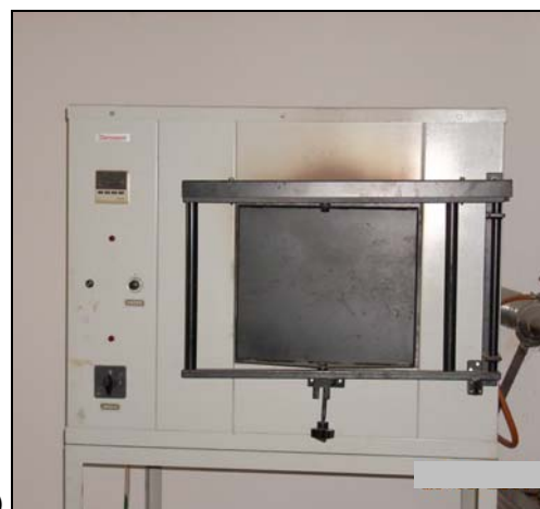
α) Η συσκευή ανάλυσης με περίθλαση ακτίνων X (X-Ray Diffractometer D5000 Siemens) της Σχολής Χημικών Μηχανικών του Ε.Μ.Π και β) ο φούρνος (Thermawatt) του Εργαστηρίου Ναυπηγικής Τεχνολογίας της Σχολής Ναυπηγών Μηχανολόγων Μηχανικών για την πραγματοποίηση των θερμικών κατεργασιών.
