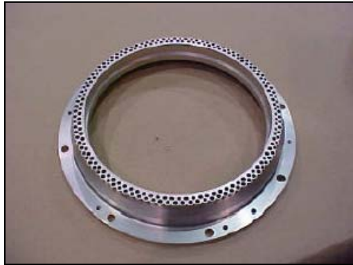
Σχήμα 1.33: Ο δακτύλιος πολλαπλής εξαγωγής από ανοξείδωτο χάλυβα, που έχει υποστεί μηχανουργική κατεργασία για τη σύνδεση με τους σωλήνες χαλκού [Haynes et al. 2003].
