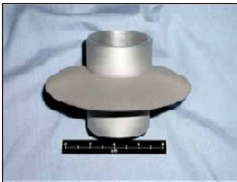
Σχήμα 1.38: α) Πτερύγιο από Ti6Al4V που ψεκάστηκε σε κύλινδρο από αλουμίνιο με διάμετρο 50 mm και β) συμμετρικό σχήμα από Ti6Al4V που ψεκάστηκε σε επίπεδο υπόστρωμα αλουμινίου πάχους 3 mm [Blose 2005b].
