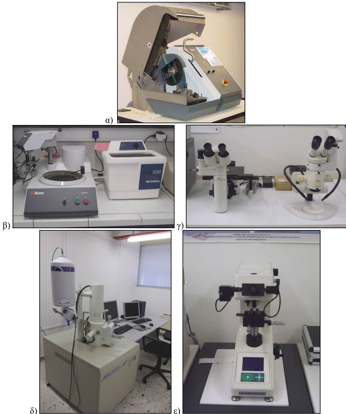
Σχήμα 2.7: Εξοπλισμός του Εργαστηρίου Ναυπηγικής Τεχνολογίας της Σχολής Ναυπηγών Μηχανολόγων Μηχανικών: α) αυτόματη κοπτική συσκευή δοκιμών (DISCOTOME-50), β) λειαντικό μηχάνημα (Struers LaboPol-5) και συσκευή καθαρισμού με υπερήχους (Branson 3510), γ) ανάστροφο μεταλλογραφικό μικροσκόπιο (Leica DMILM) και τριοφθάλμιο στερεοσκόπιο (Leica MZ6) με φωτιστική πηγή ψυχρού φωτισμού, δ) μικροσκληρόμετρο (Wolpert Wilson Instruments TM , 402MVD) και ε) ηλεκτρονικό μικροσκόπιο σάρωσης (SEM) (Jeol, JSM-6390).
