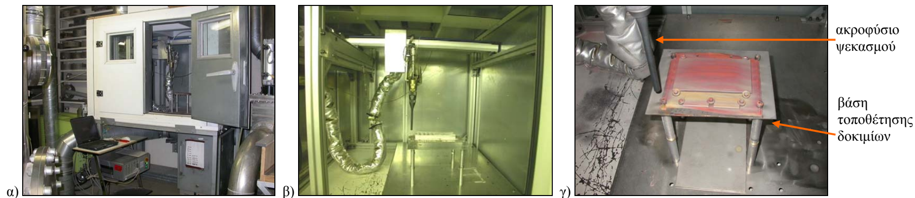
Σχήμα 2.2: α) Εξωτερική άποψη του θαλάμου ψυχρού ψεκασμού, β) εσωτερικό του θαλάμου και γ) το ακροφύσιο ψεκασμού και η τράπεζα πάνω στην οποία βρίσκεται πλάκα Al2017, η οποία έχει επικαλυφθεί με \text{Cu}+\text{Al}_2\text{O}_3 .
