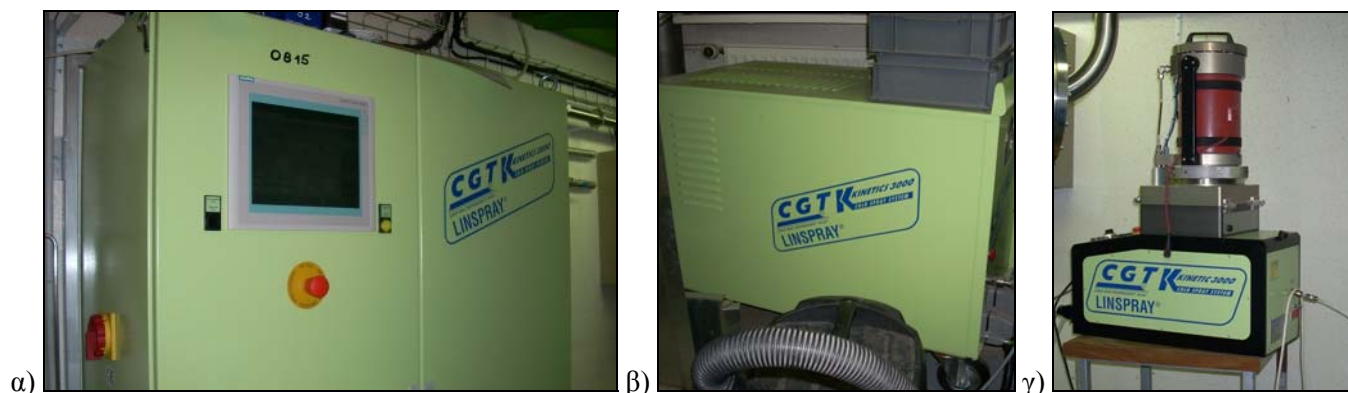
Σχήμα 2.1: Ο εξοπλισμός της École Nationale Supérieure des Mines de Paris, που χρησιμοποιήθηκε για τον ψυχρό ψεκασμό: α) η μονάδα ελέγχου μέσω της οποίας γίνεται η ρύθμιση των παραμέτρων ψεκασμού, β) η μονάδα θέρμανσης του αερίου της διεργασίας και γ) ο τροφοδότης της σκόνης ψεκασμού.
