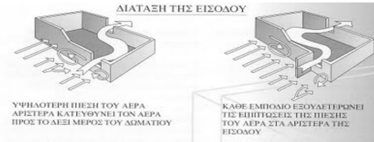
Εικόνα 9.4. Ο ρόλος των εξωτερικών στοιχείων στον αερισμό του εσωτερικού χώρου
