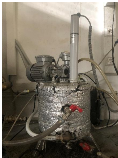
Εικόνα 23: Αναερόβιος Αντιδραστήρας Μεμβρανών (AnMBR) στην Ημυβιομηχανική Μονάδα της Σχολής
