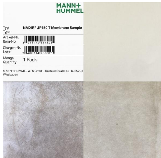
Εικόνα 29: Πάνω Αριστερά: Κωδική ονομασία μεμβράνης/Πάνω Δεξιά: 40nm PES/Κάτω Αριστερά: 40nm PES Coated (Front Side)/Κάτω Δεξιά: 40nm PES Coated (Back Side)
