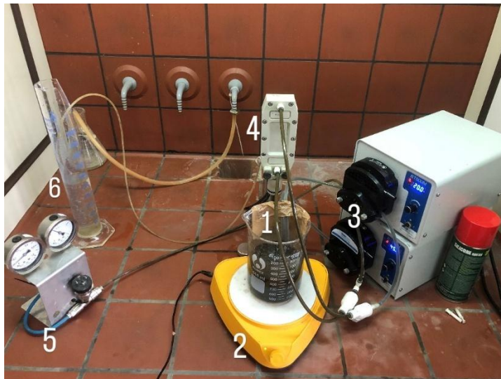
Εικόνα 22: Πειραματική Διάταξη τύπου Batch συστήματος μεμβρανών
