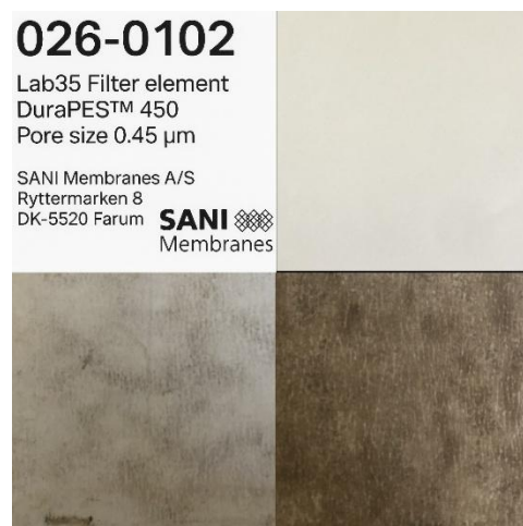
Εικόνα 30: Πάνω Αριστερά: Κωδική ονομασία μεμβράνης/Πάνω Δεξιά: 450nm PES/Κάτω Αριστερά: 450nm PES Coated (Front Side)/Κάτω Δεξιά: 450nm PES Coated (Back Side)
