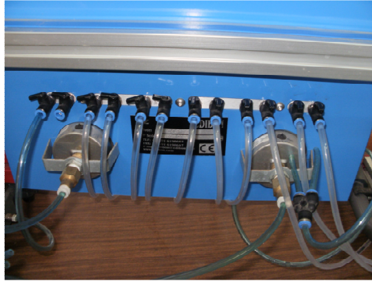
Σχήμα 2.10 Διακόπτες εισόδου στους σωλήνες του διαφορικού μανομέτρου με αέρα για την κατά περίπτωση επιλογή των πιεζόμετρων.
