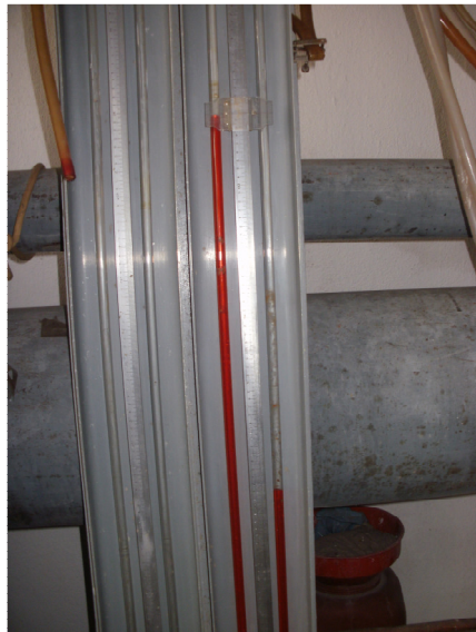
Σχήμα 4.1 Διαφορικό μανόμετρο τετραχλωράνθρακα. Η ένδειξη αντιστοιχεί στη μέγιστη παροχή που χρησιμοποιήθηκε. ( \Delta h = 522\text{mm} ή Q = 14.25\text{ L/s} )
