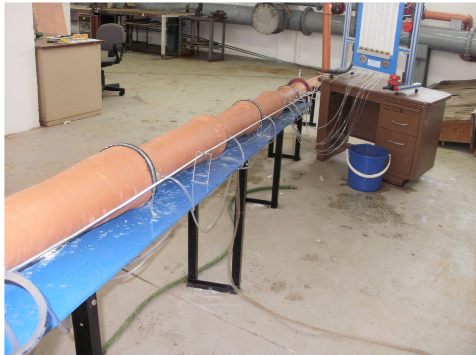
Σχήμα 2.6 Διάταξη των πιεζόμετρων κατά μήκος της συστοιχίας των έξι πηλοσωλήνων σε σειρά.
