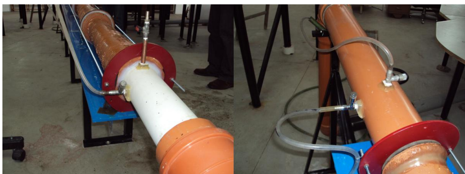
Σχήμα 2.7 Θέσεις πιεζόμετρων στο πλάι και εξαεριστικών στην άντρυγα των σωλήνων PVC στην είσοδο και έξοδο της συστοιχίας ηηλοσωλήνων.
