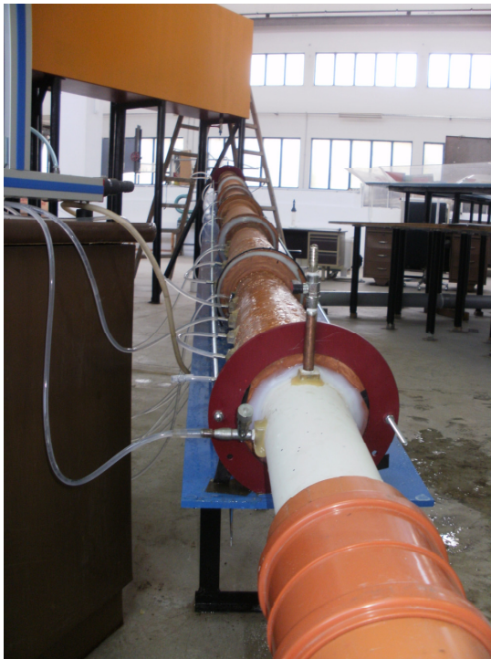
Σχήμα 2.6 Διάταξη των πιεζόμετρων κατά μήκος της συστοιχίας των έξι πηλοσωλήνων σε σειρά.
