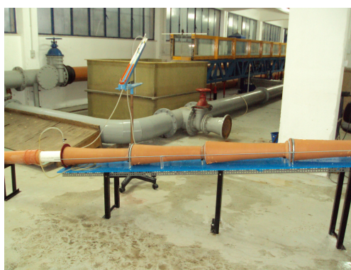
Σχήμα 2.8 Μετρήσεις με κεκλιμένο διαφορικό μανόμετρο με τετραχλωράνθρακα.
