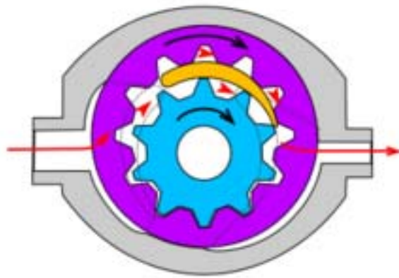
Σχήμα 5.13: Οδοντωτή αντλία με κινητήριο τροχό εσωτερικής οδόντωσης.
