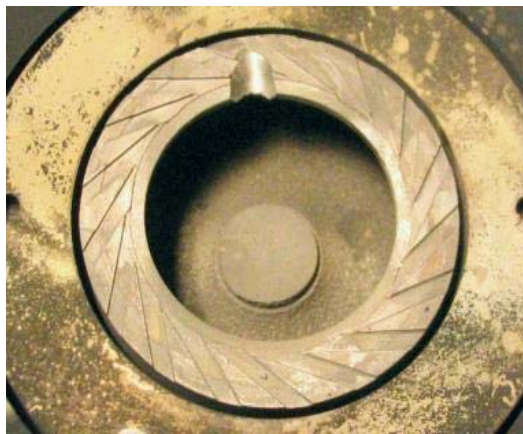
Σχήμα 4.1: Θάλαμος καύσης κατασκευασμένος από κεραμικό υλικό.
