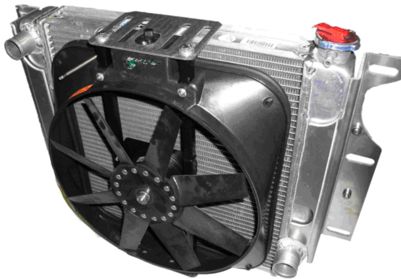
Σχήμα 2.42: Ανεμιστήρας κινητήρα τοποθετημένος πίσω από το ψυγείο
