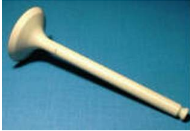
Σχήμα 4.4: Βαλβίδα επικαλυμμένη με silicon nitride.
