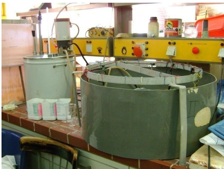
Εικόνα 8. 8: Λουτρό Εμβάπτισης Εργαστηρίου Χ.Μ.Μ.
