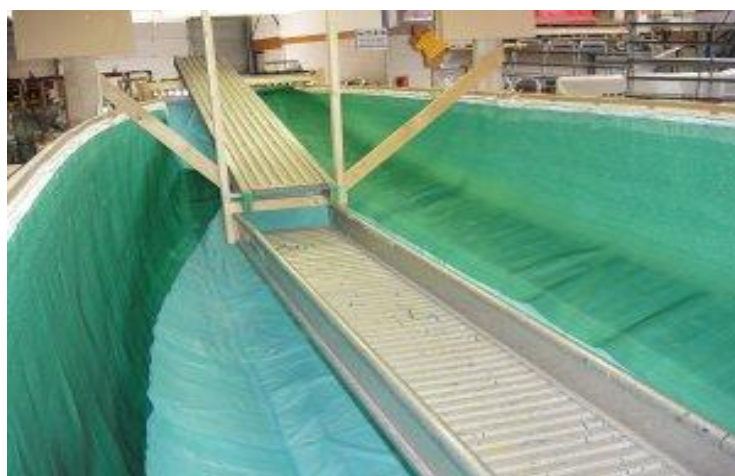
Εικόνα 6. 5. Προετοιμασία Μεθόδου Έκχυσης Ρητίνης σε Σάκο Κενού –V.I.P.
