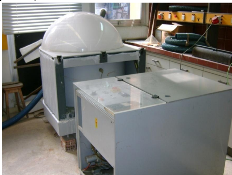
Εικόνα 8. 7: Θάλαμος Αλατονέφωσης Εργαστηρίου Χ.Μ.Μ.
