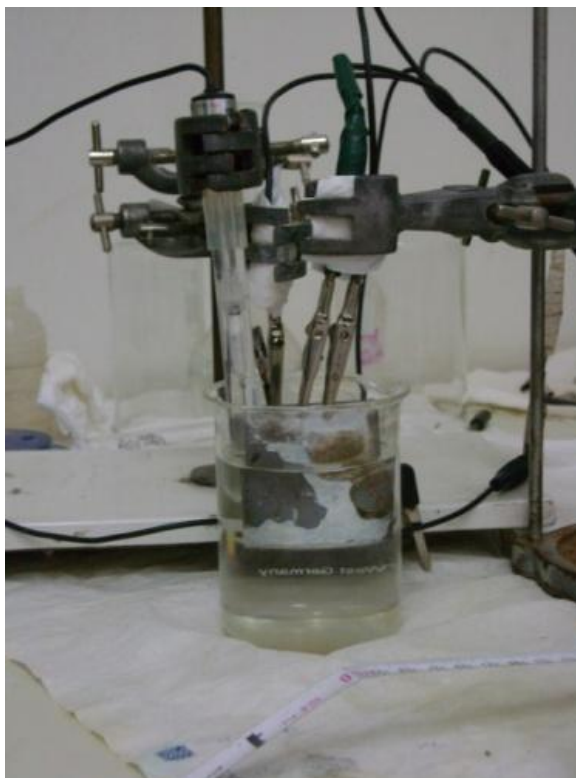
Εικόνα 9. 4 : Η Μέθοδος Tafel στο Εργαστήριο της Σχολής Χ.Μ.Μ.
