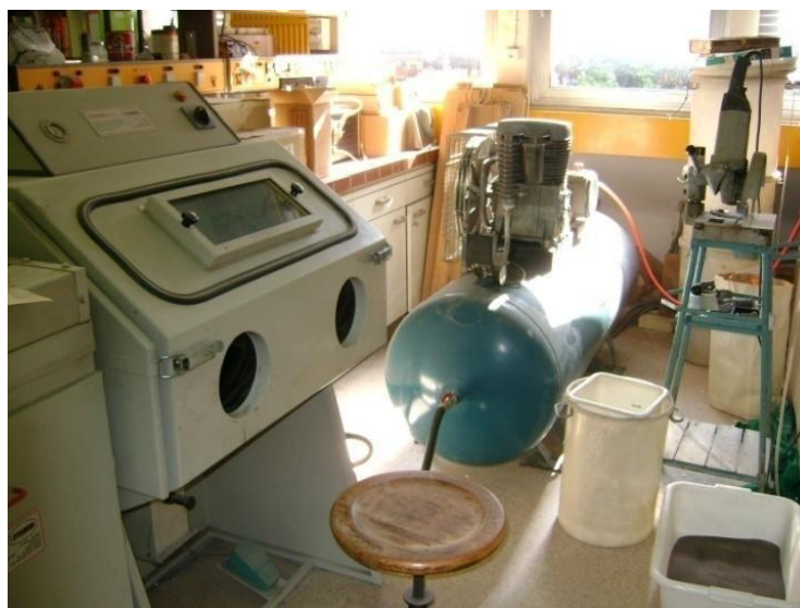
Εικόνα 8. 2: Θάλαμος Ψηγματοβολής Εργαστηρίου Χ.Μ.Μ.
