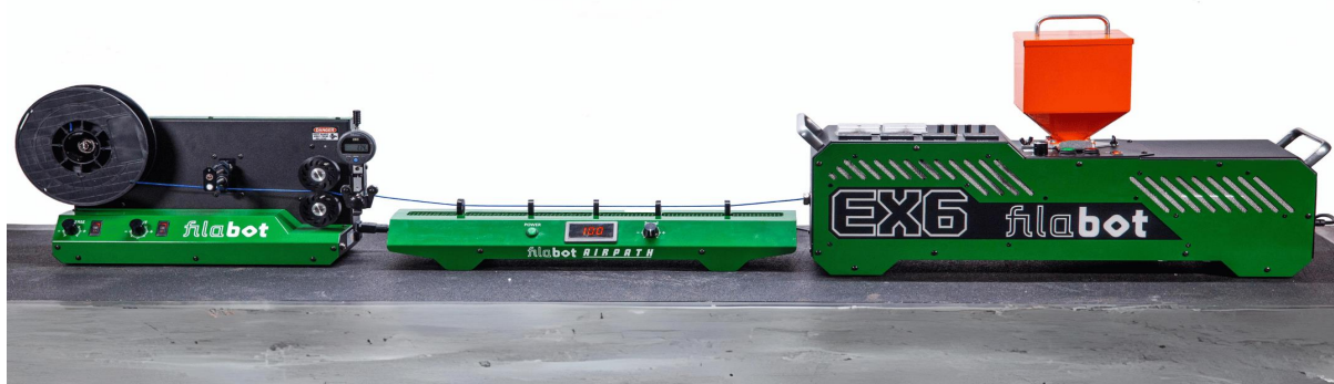
Εικόνα 5 – Διάταξη εκβολέα νήματος
