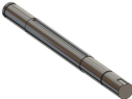
Εικόνα 25 – Άξονας της κατασκευής σε CAD γεωμετρία
