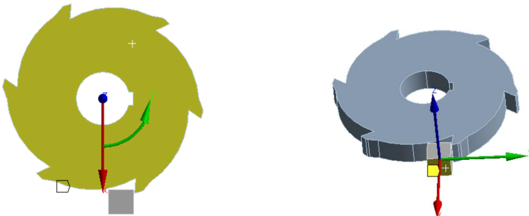
Εικόνα 11 – Οριακές συνθήκες λεπίδας & πακτωμένο face αποβλήτου
