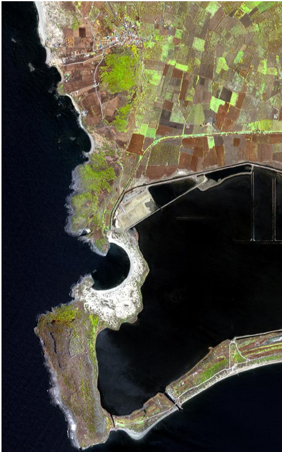
Πολυφασματική ψηφιακή τηλεπισκοπική απεικόνιση από το δορυφόρο IKONOS της 3-6-2000: έγχρωμο σύνθετο 3,2,1, NIR (R,G,B,I).
