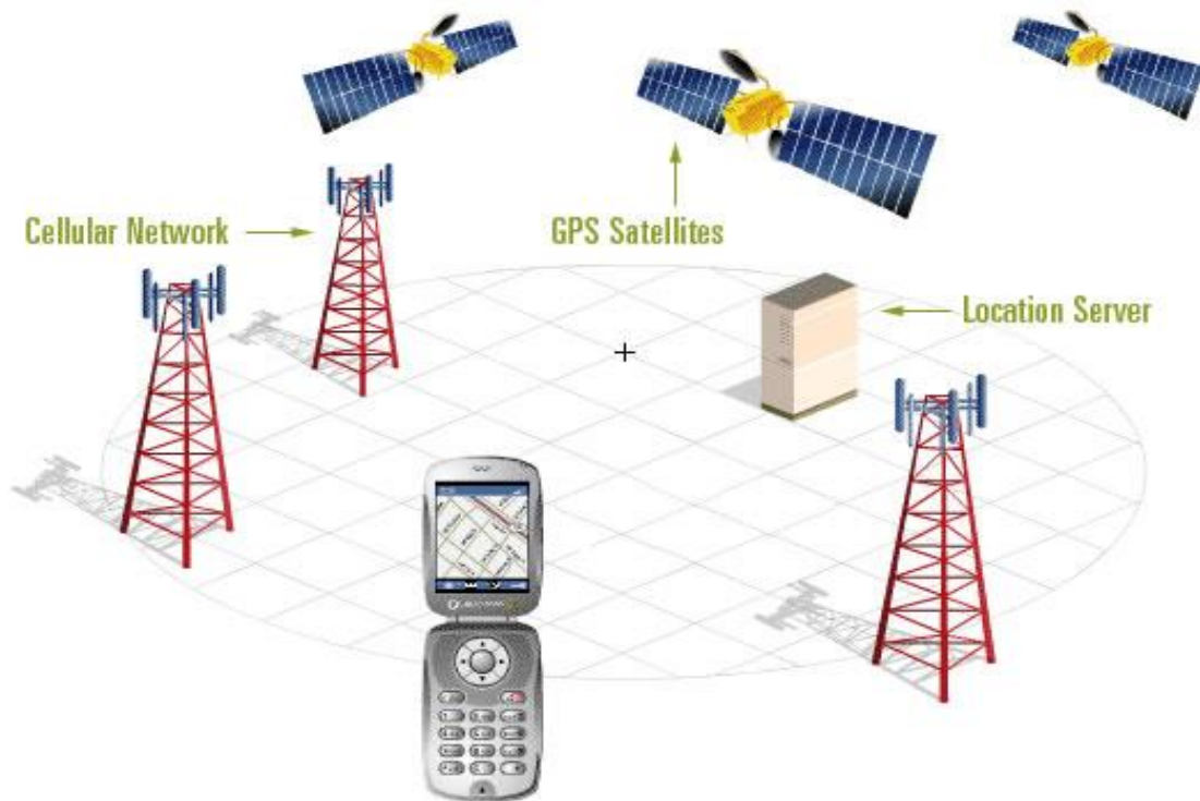
Σχήμα 5. Η δομή του A-GPS
