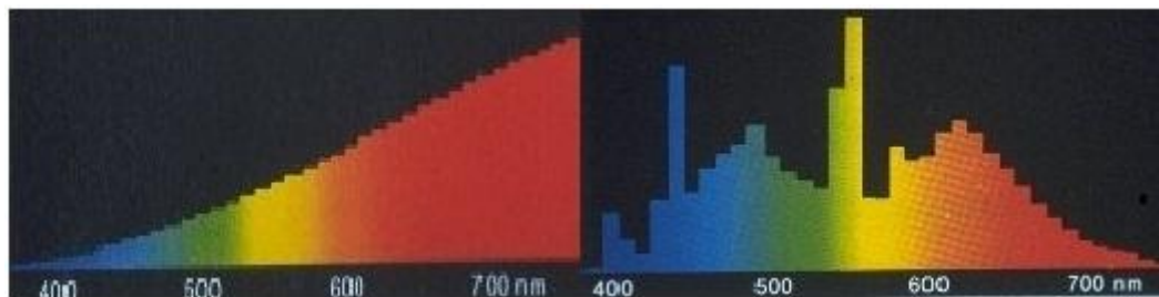
Εικόνα 2.2. Σύγκριση της φασματικής σύστασης του φωτός τυπικών πηγών πυρακτώσεως (αριστερά) και φθορισμού (δεξιά). Το φως των πηγών φθορισμού έχει μεγαλύτερη περιεκτικότητα σε χαμηλές συχνότητες.
