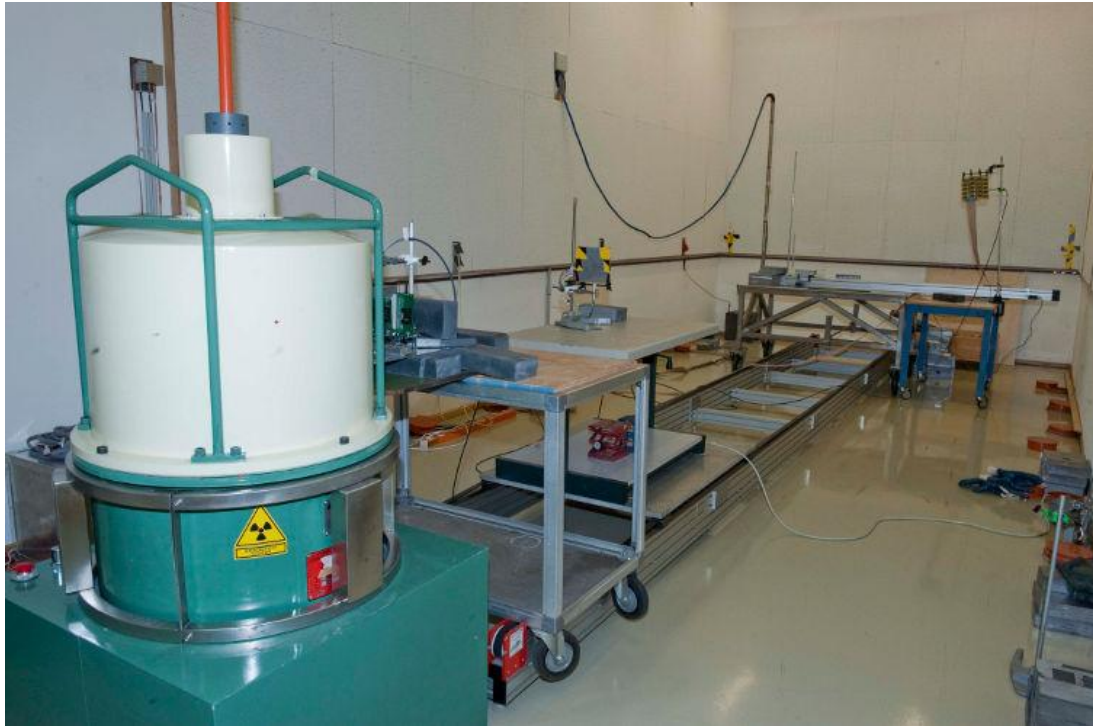
Σχήμα 9.3: Εικόνα του εργαστηρίου ακτίνων - γ. Οι τοίχοι έχουν ενισχυθεί με μόλυβδο και η πηγή του ^{60}\text{Co} βρίσκεται μέσα σε νερό κάτω από τον πράσινο θάλαμο.
