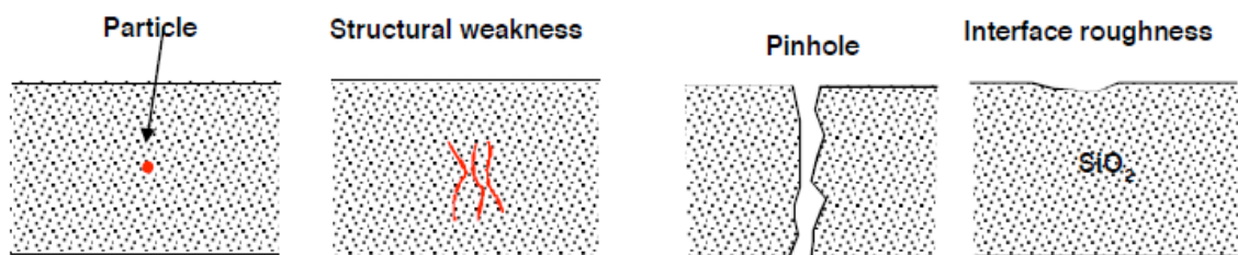
Σχήμα 3.17: Απεικόνιση της ενδογενούς κατάρρευσης του \text{SiO}_2 .
