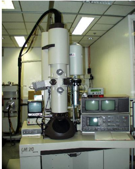
Σχήμα 5.23: Εικόνα του μικροσκοπίου διέλευσης ηλεκτρονίων (TEM) τύπου Philips CM20 το οποίο χρησιμοποιήθηκε για τον δομικό χαρακτηρισμό των δειγμάτων.
