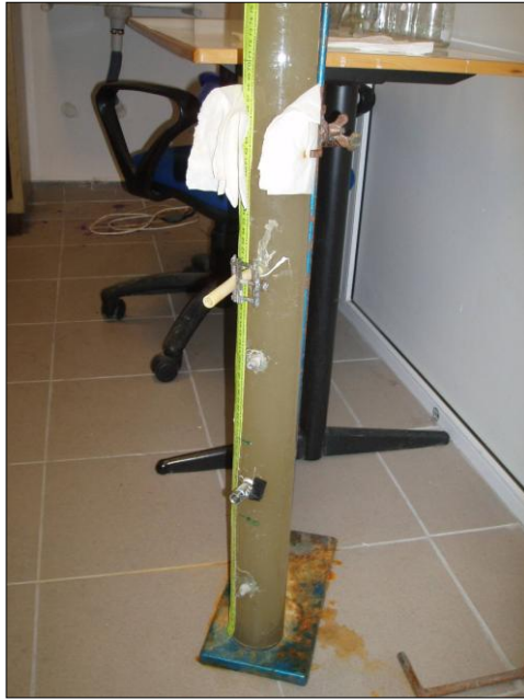
Εικόνα 2-6 Στήλη καθίζησης ύψους 100 cm και διαμέτρου 6,4 cm
