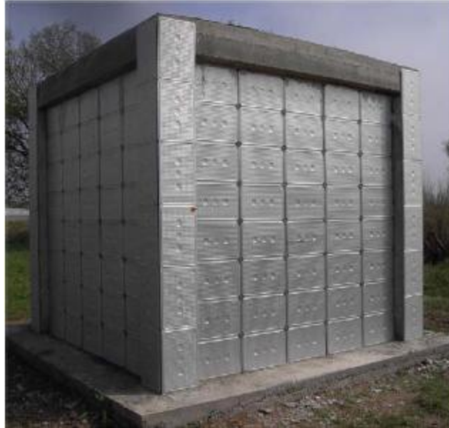
Σχήμα 2.1.23: Πειραματικός θαλαμίσκος πλινθοδομής με RT-27 και πολουρεθάνη [58].
