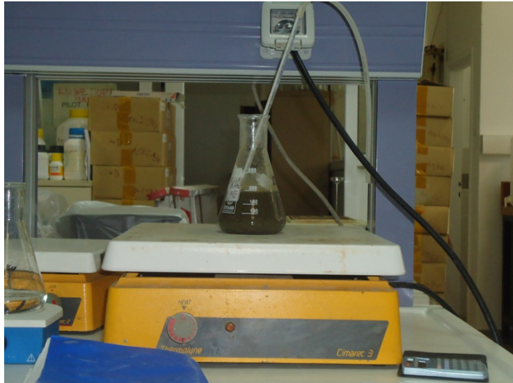
Εικόνα 3.13: Προετοιμασία δείγματος: θέρμανση στους 37 °C και ανάδευση
