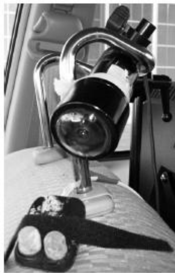
Εικόνα 2.1: Κάμερες που χρησιμοποιήθηκαν για την καταγραφή διαφόρων παραμέτρων στο ειδικά εξοπλισμένο όχημα
