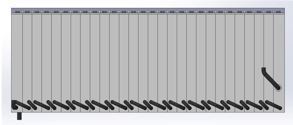
Εικόνα 13: Πρόσωση 1ου σταδίου ηλεκτρόλυσης Chlor-Alkali
