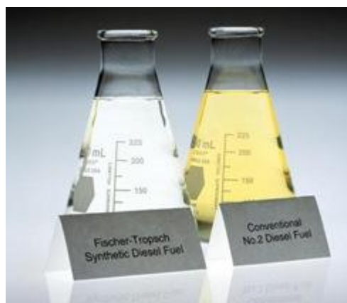
Εικόνα 1: Σύγκριση συνθετικού και συμβατικού ντήζελ. Το συνθετικό είναι πιο διαυγές λόγω της σχεδόν μηδενικής παρουσίας θείου και αρωματικών
