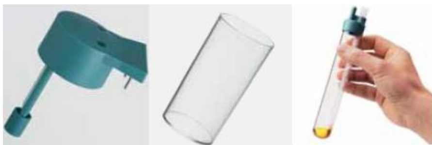
Εικόνα 24: α) κελί αγωγιμότητας β) δοχείο όπου μετριέται η αγωγιμότητα γ) φιαλίδιο αντίδρασης
