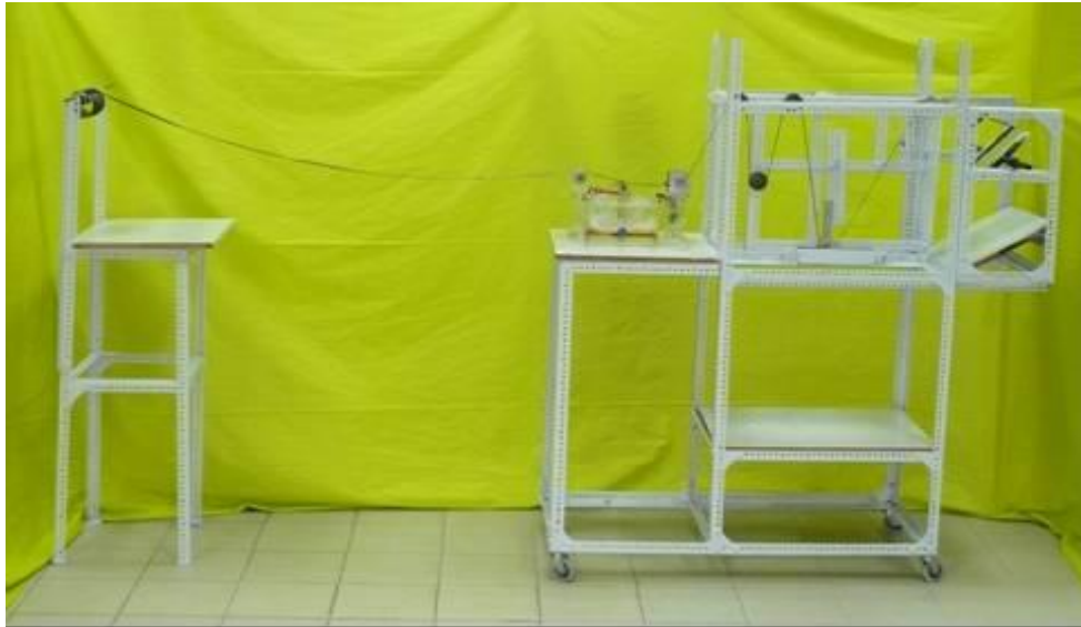
Εικόνα 53. Εργαστηριακή διάταξη που χρησιμοποιήθηκε για προδιαπότιση των ινών
