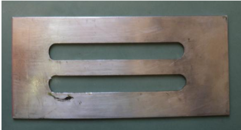
Εικόνα 57 . Μεταλλικό καλούπι κλειστού τύπου για την μορφοποίηση του τελικού συνθέτου
