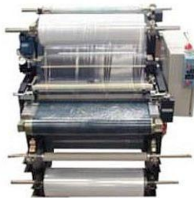
Εικόνα 51. Μηχάνημα παραγωγής pre-preg ινών
