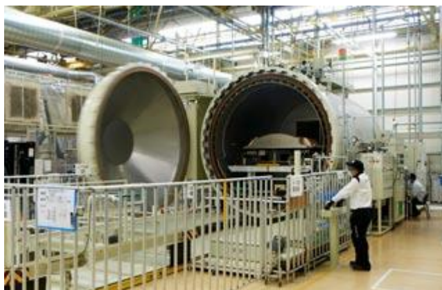
Εικόνα 9. Κλίβανοι ωρίμανσης της αυτοκινητοβιομηχανίας LEXUS
