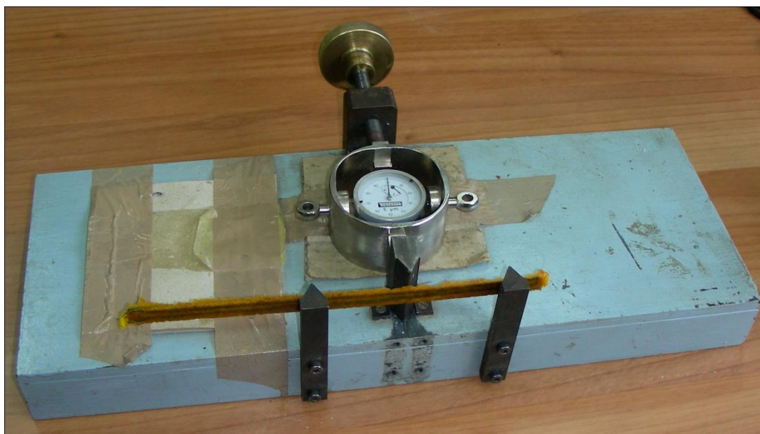
Σχήμα 9. Διάταξη μέτρησης δοκιμής σε κάμψη και διάτμηση
