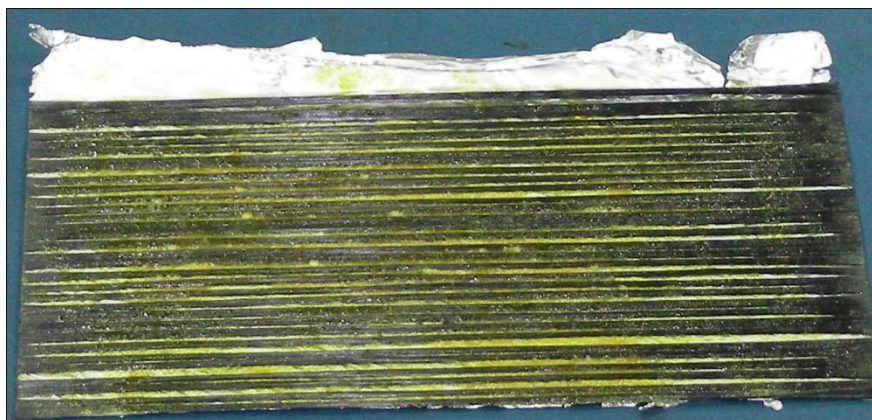
Εικόνα 52. Διαβρεγμένες ίνες αφού αποκόπηκαν από την πλάκα αλουμινίου
