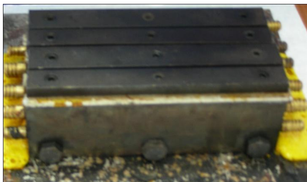
Εικόνα 54. Μεταλλικό καλούπι ανοιχτού τύπου για την μορφοποίηση του τελικού συνθέτου
