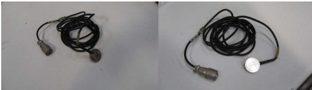
Εικόνα 6.6. Το πιεσόμετρο KYOWA BE-5KC που χρησιμοποιήθηκε στις πειραματικές μετρήσεις
