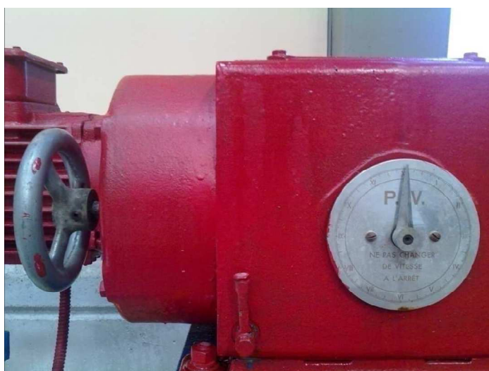
Εικόνα 6.5. Το κιβώτιο ταχυτήτων της κυματογεννήτριας το οποίο καθορίζει τις περιόδους του παραγόμενου κυματισμού
