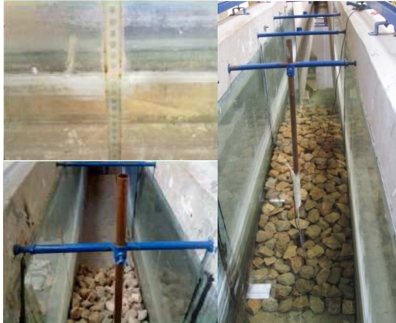
Εικόνα 6.10. Οριζόντιοι υποδοχείς των ανοξείδωτων σωλήνων και βαθμονομημένος γνώμονας για τις οπτικές παρατηρήσεις
