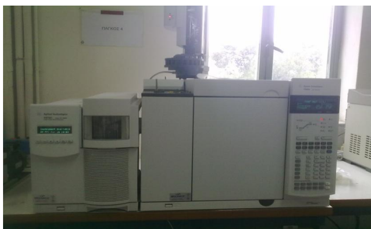
Εικόνα 3.22 Αέριος χρωματογράφος τύπου Agilent 7890A συζευγμένος με φασματογράφο μάζας Agilent 5975C
