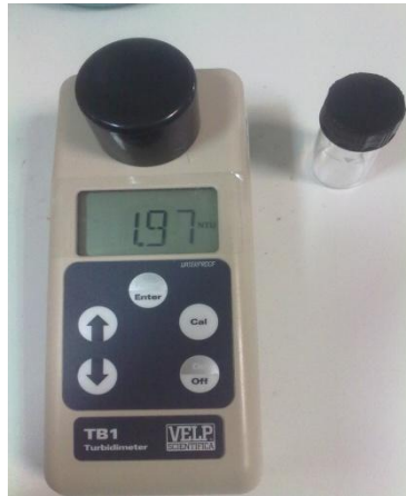
Εικόνα 3.17 Θολόμετρο Hach Turbidity meter
