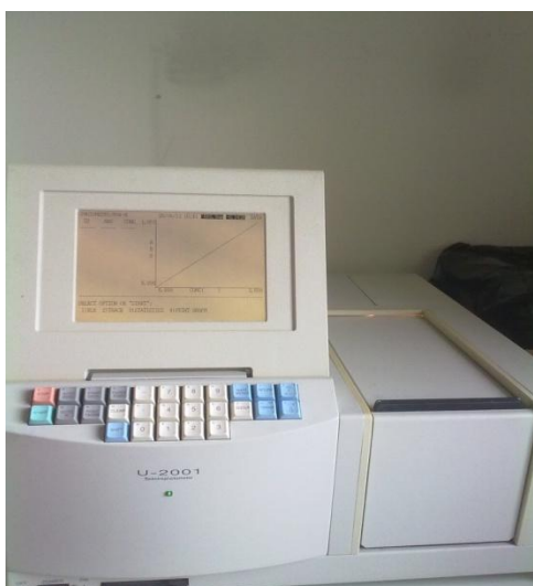
Εικόνα 3.16 Φασματοφωτόμετρο για τη μέτρηση της % διαπερατότητας
