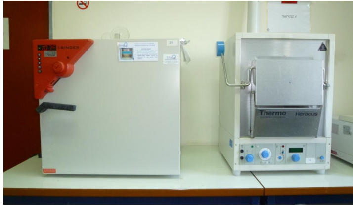
Εικόνα 3.19 Φούρνοι για τον προσδιορισμό ολικών (αριστερά) και οργανικών (δεξιά) στερεών
