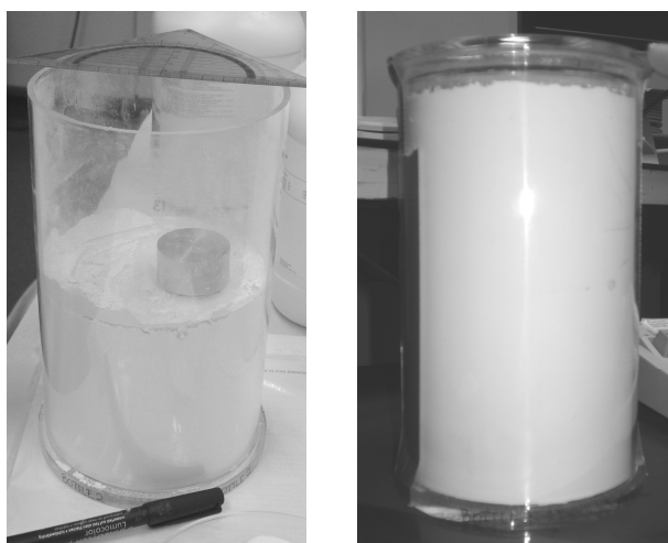
Σχήμα 5.1 α) Ο κυλινδρικός δίσκος τοποθετημένος στο εσωτερικό του δείγματος και β) το δείγμα πλήρες με σκόνη χαλαζία (Quartz)
