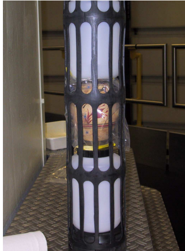
Σχήμα 7.2. Το κεραμικό αγγείο τοποθετημένο στο πλέγμα πολυαιθυλενίου
