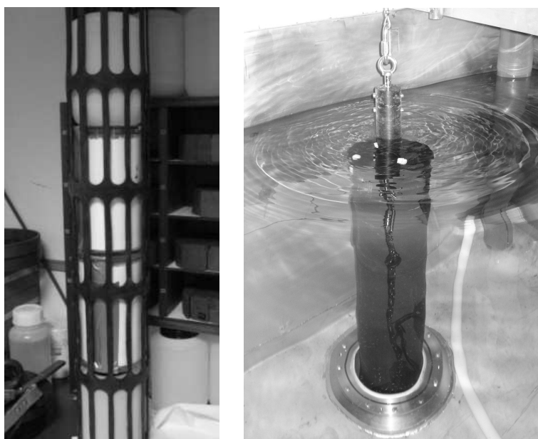
Σχήμα 5.2 α) το δείγμα μέσα στο πλέγμα πολυαιθυλενίου β) το δοχείο που περιέχει το δείγμα κατά τη βύθισή του στον αγωγό ακτινοβόλησης
