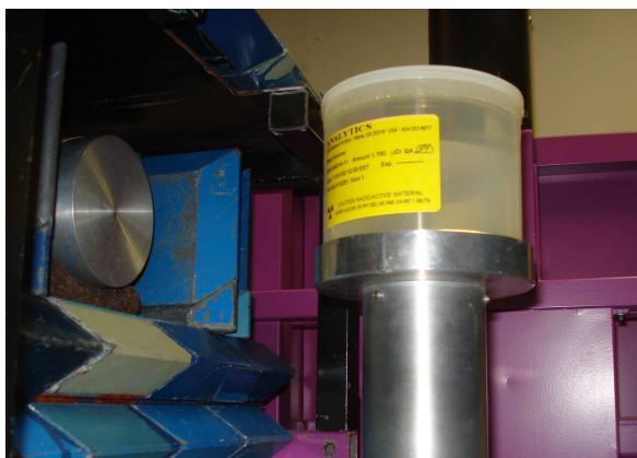
Σχήμα 5.6 Η πηγή όγκου Marinelli που χρησιμοποιήθηκε ως γεωμετρία αναφοράς
