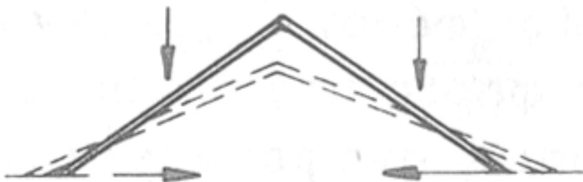
Εικόνα 5. Όταν ο φορέας αποτελείται από δύο απλά δοκάρια (αμείβοντες), προκαλούνται ωθήσεις στους τοίχους Οικοδομική / Ζ. Α. Τζαρτζάνου
