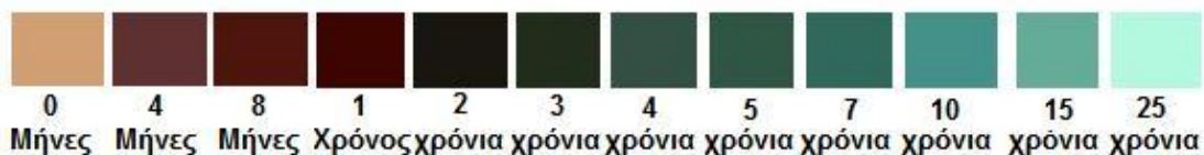
Εικόνα 101 Μεταβολή του χρώματος του χαλκού από την οξείδωση.
