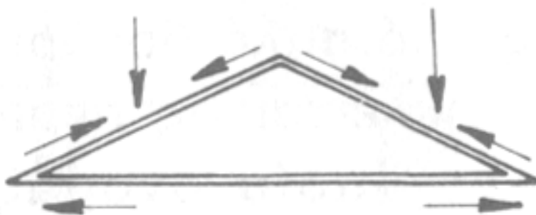
Εικόνα 6. Με την προσθήκη ελκυστήρα πετυχαίνουμε την εξουδετέρωση των πλάγιων ωθήσεων Οικοδομική / Ζ. Α. Τζαρτζάνου
