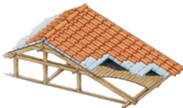
Εικόνα 43 Θερμομόνωση στεγών με επικάλυψη κεραμιδιών
