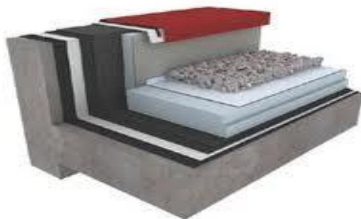
Εικόνα 40 Θερμομόνωση συμβατικού τύπου δώματος ( www.steganosi.blogspot.com )
