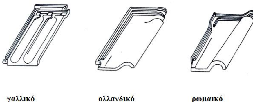
Εικόνα 71 Χαρακτηριστικά πτυχωτά και κυματοειδή κεραμίδια (γαλλικό, ολλανδικό, ρωμαϊκό).
