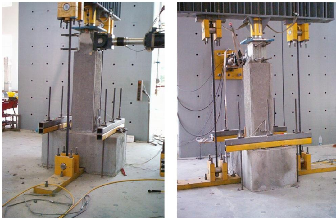
Εικ.5.1 Εργαστηριακή διάταξη επιβολής στηρίξεων και φορτίσεων (Βανδώρος, 2005)
