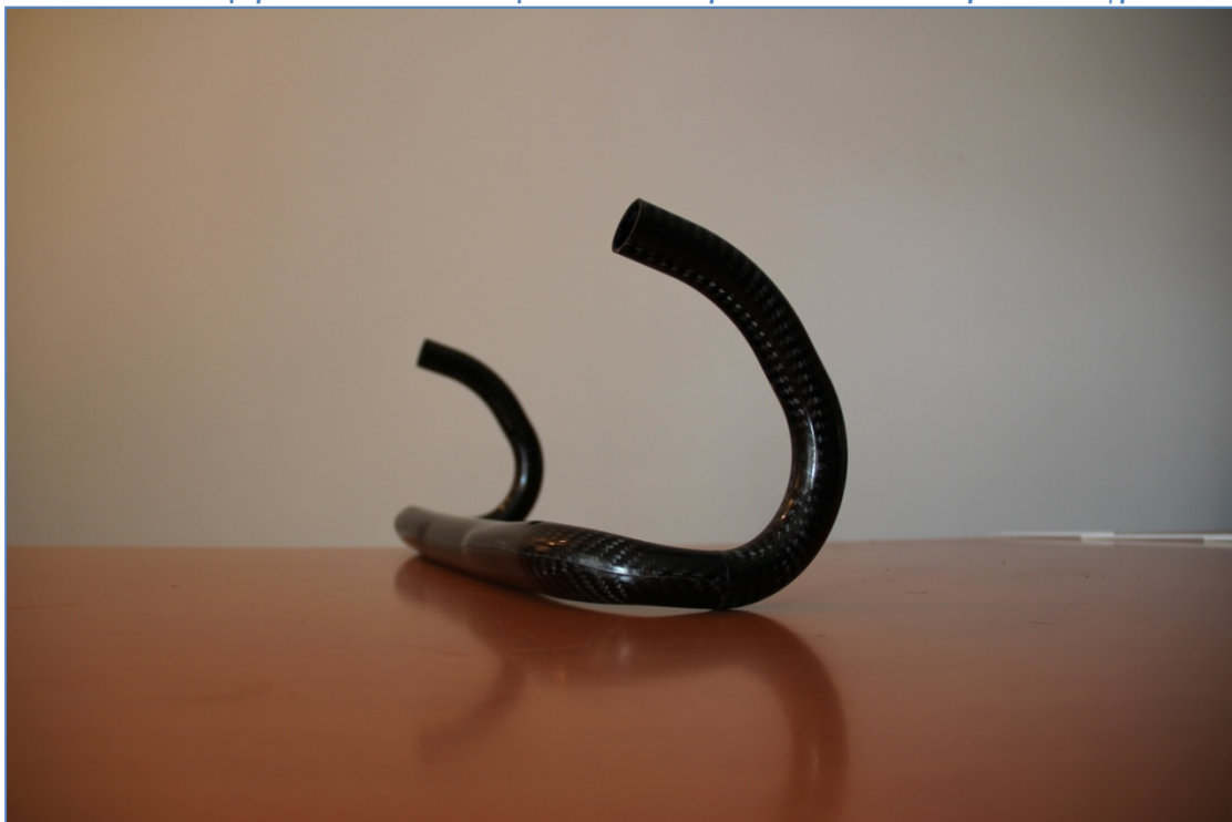
Εικόνα 129: Παρατηρήστε την αλλαγή καμπυλότητας του τιμονιού για την καλύτερη επαφή του με το χέρι του αναβάτη (κενό με το τραπέζι)
