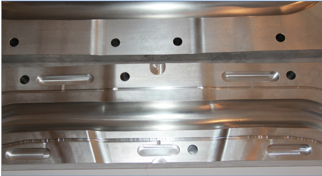
Εικόνα 100: Λεπτομέρεια κεντρικού κομματιού - Αυλάκια συγκράτησης της ρητίνης και εγκοπές για την χρήση μοχλού σε περίπτωση που δεν δουλέψουν οι εξολκείς
