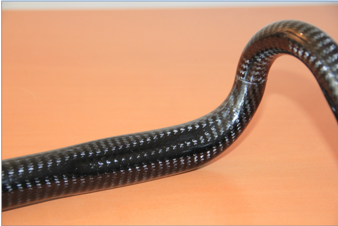
Εικόνα 128: Λεπτομέρεια - Το αυλάκι του τιμονιού που θα περνά το καλώδιο των λεβιέδων των φρένων - 2
