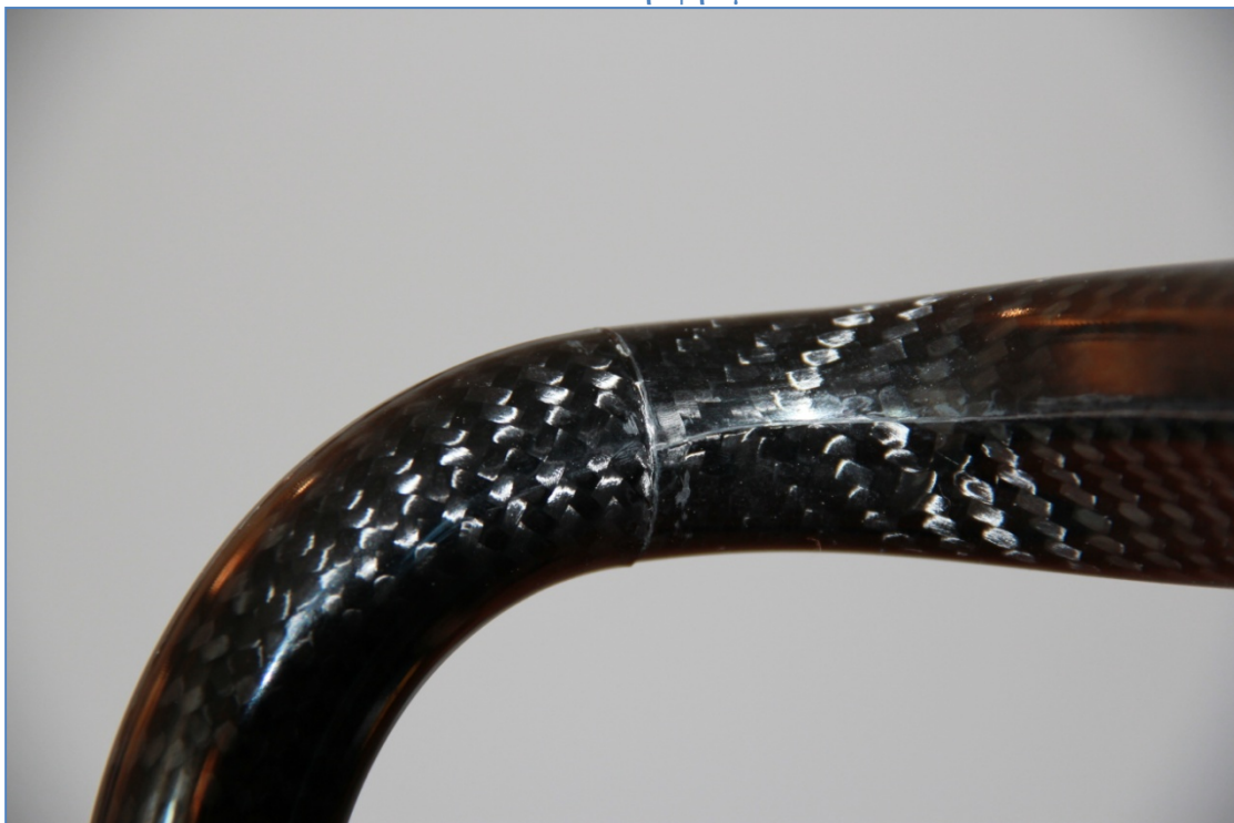
Εικόνα 124: Λεπτομέρεια - φαίνονται οι αρμοί του καλουπιού και οι πλέξεις του ανθρακονήματος
