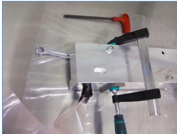
Εικόνα 114: Σύσφιξη τμημάτων καλουπιού με ακρίβεια
