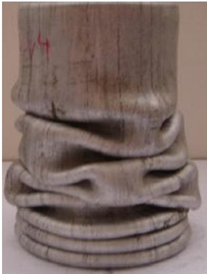
Σχήμα 17: Δοκίμιο με μικτό τρόπο κατάρρευσης [21]
