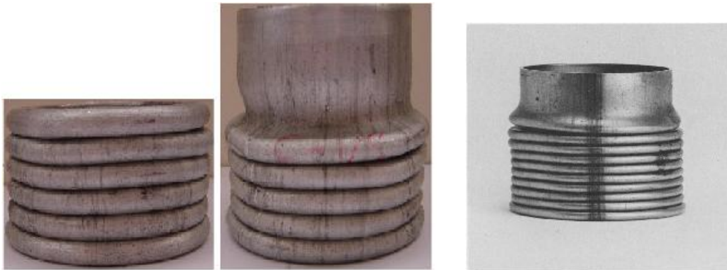
Σχήμα 1: Αξονοσυμμετρικός τρόπος κατάρρευσης [21],[11]
