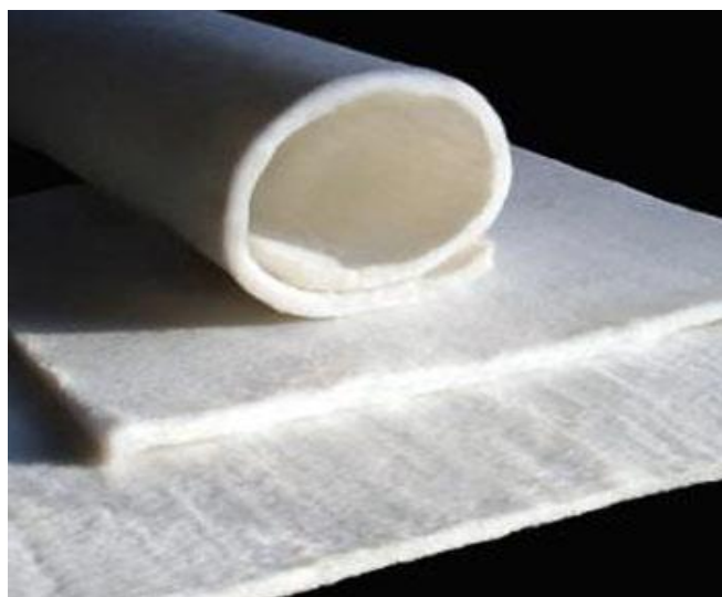
Εικόνα 5.13: Θερμομονωτικά φύλλα από Aerogel (Πηγή: http://www.treehugger.com/sustainable-product-design/space-age-tech-coming-to-a-building-near-you-aerogel-as-insulation.html )
