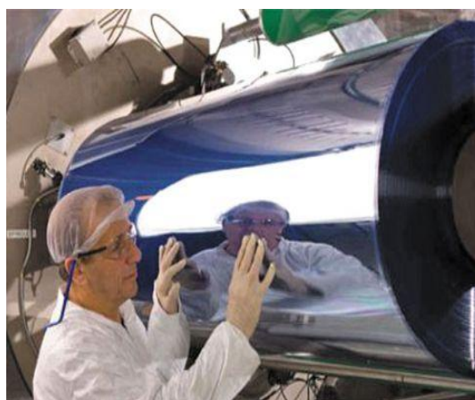
Εικόνα 1.11: OPV φωτοβολταϊκά σε μορφή πλαστικού film σε ρολό (Πηγή:
