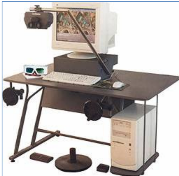
εικόνα 2.1.3.1β: Φωτογραμμετρικός σταθμός "Delta" ( http://www.citymap.md/ingecad/EN/fotogrammetriya )
