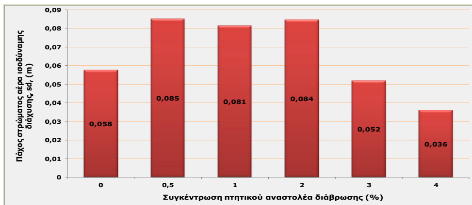
Σχήμα ΙΙ2: Συγκριτικό διάγραμμα του συντελεστή s_d , (m), για την επικάλυψη VCI, για διάφορες συγκεντρώσεις πηκτικού αναστολέα διάβρωσης.
