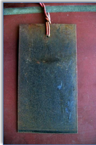
Εικόνα ΙΙΙ 2: Ενδεικτικές φωτογραφίες επίπεδων δοκιμίων χάλυβα με επικάλυψη με ανόργανο μετατροπέα οξειδίων του σιδήρου, σε χρόνο t=0 και μετά από 24 μήνες έκθεσης στην ατμόσφαιρα
