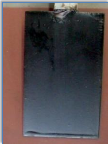
Εικόνα ΙΙΙ 2: Ενδεικτικές φωτογραφίες επίπεδων δοκιμίων χάλυβα με επικάλυψη με ανόργανο μετατροπέα οξειδίων του σιδήρου, σε χρόνο t=0 και μετά από 24 μήνες έκθεσης στην ατμόσφαιρα
