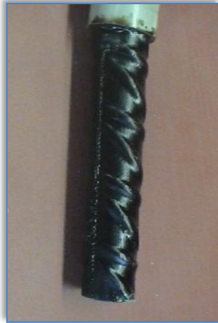
Εικόνα ΙΙΙ 1: Ενδεικτικές φωτογραφίες δοκιμίων χάλυβα οπλισμού σκυροδέματος με επικάλυψη με ανόργανο μετατροπέα οξειδίων του σιδήρου, σε χρόνο t=0 και μετά από 24 μήνες έκθεσης στην ατμόσφαιρα
