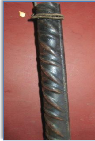
Εικόνα ΙΙΙ 1: Ενδεικτικές φωτογραφίες δοκιμίων χάλυβα οπλισμού σκυροδέματος με επικάλυψη με ανόργανο μετατροπέα οξειδίων του σιδήρου, σε χρόνο t=0 και μετά από 24 μήνες έκθεσης στην ατμόσφαιρα
