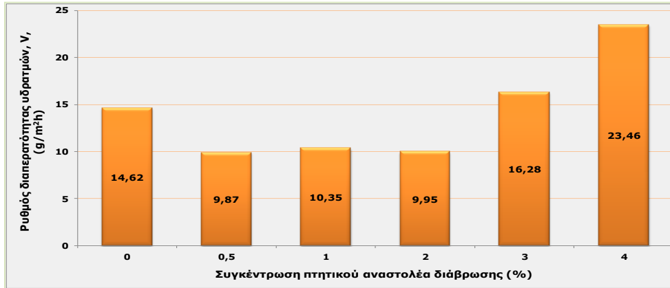
Σχήμα ΙΙ1: Συγκριτικό διάγραμμα του ρυθμού διαπερατότητας σε υδρατμούς ( V , g/m 2 h) για την επικάλυψη VCI, για διάφορες συγκεντρώσεις πηκτικού αναστολέα διάβρωσης.
