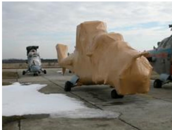
Σχήμα 3.6: Συσκευασία για προστασία αεροσκάφους με φιλμ εμποτισμένο με πτητικό αναστολέα διάβρωσης [112]
