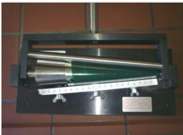
Εικόνα 6.4: Conical Mandrel Bend tester, Simex
