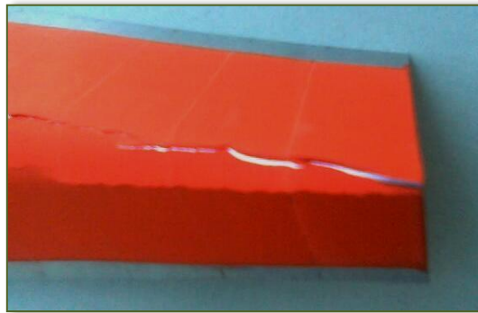
Εικόνα 6.5: Χαρακτηριστικά παραδείγματα επικαλύψεων (αστάρια μετάλλων) που παρουσιάζουν ρηγματώσεις και αποκόλληση από το υπόστρωμα μετά τη δοκιμή της αντοχής σε κάμψη [182] .
