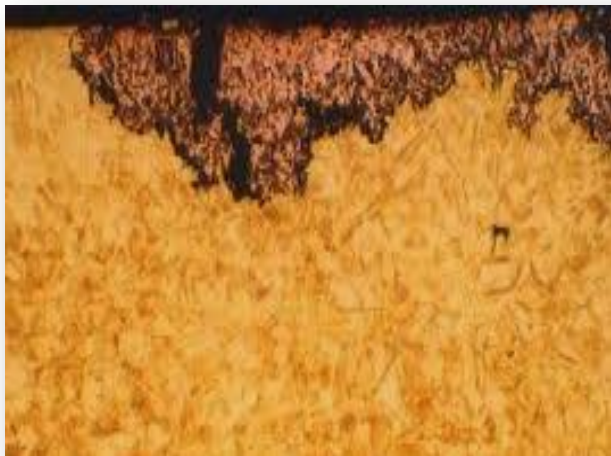
Σχήμα 1.14: Αποψευδαργύρωση του ορείχαλκου σε δείγμα σωλήνα εναλάκτη [24]
