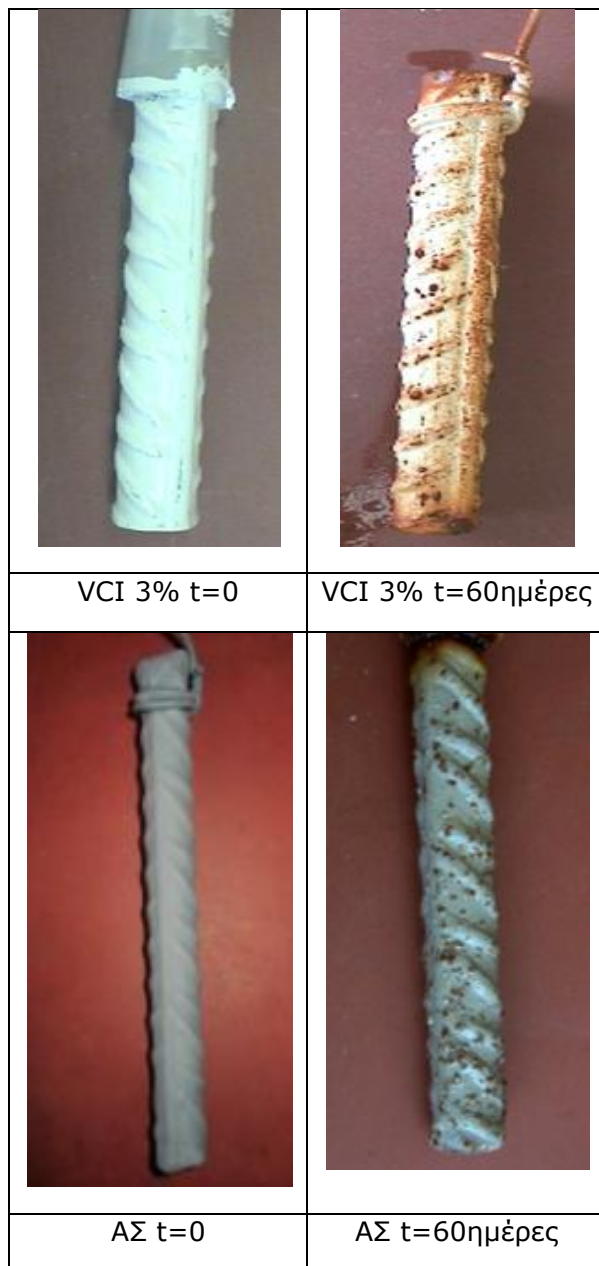
Εικόνα 9.1: Ενδεικτικές φωτογραφίες δοκιμίων χάλυβα οπλισμού σκυροδέματος με τις 2 επικαλύψεις, σε χρόνο t=0 και μετά από 60 ημέρες έκθεσης σε περιβάλλον υδατικού διαλύματος NaCl 3,5% κ.ο
