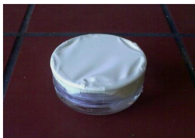
Εικόνα 6.1: Δοκίμιο για τον προσδιορισμό της διαπερατότητας σε υδρατμούς
