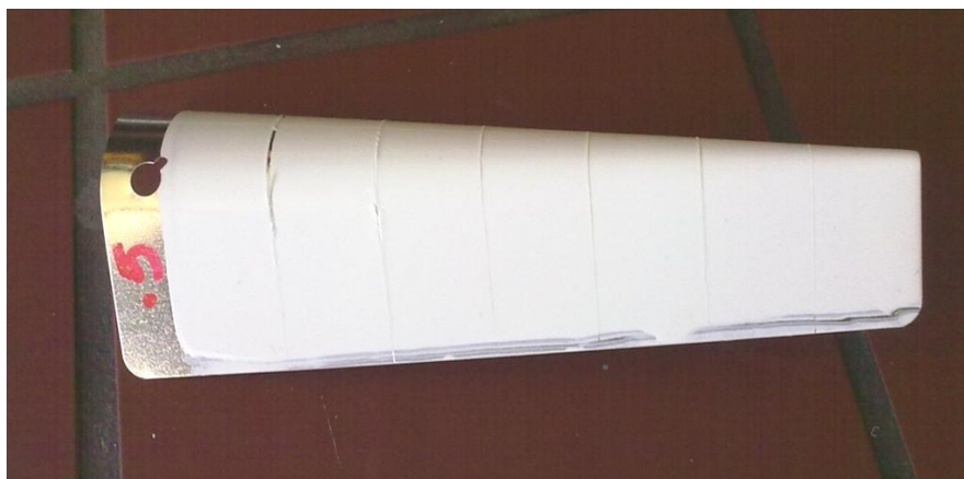
Εικόνα 8.7: Δοκίμιο επικαλυμμένο με VCI 0.5%
