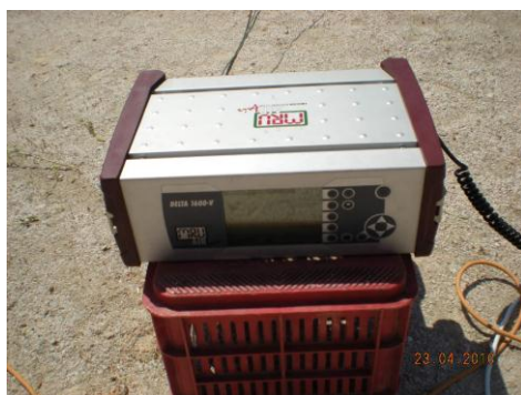
Εικόνα 63: (α) Ο αναλυτής καυσαερίων MRU Delta 1600V στο πεδίο και (β) το άκρο του σωλήνα αέριας δειγματοληψίας και το αισθητήριο του θερμοστοιχείου του αναλυτή καυσαερίων τοποθετημένα σε ύψος περίπου 3 m. Στην ίδια φωτογραφία εικονίζεται και το μικρόφωνο τοποθετημένο σε ύψος περίπου 2,5 m.
