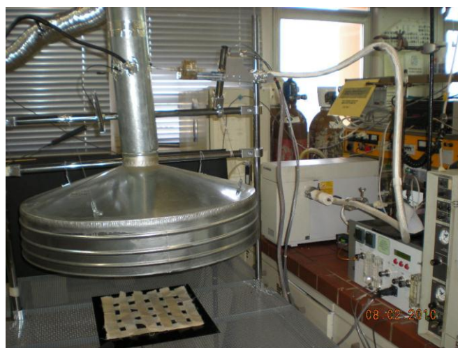
Εικόνα 22: Ο φασματογράφος μάζας HP 5972A MSD σε συνδυασμό με το δειγματοληπτικό σύστημα PSS, σε διάταξη για την παρακολούθηση των πειραμάτων καύσης εργαστηριακής κλίμακας
