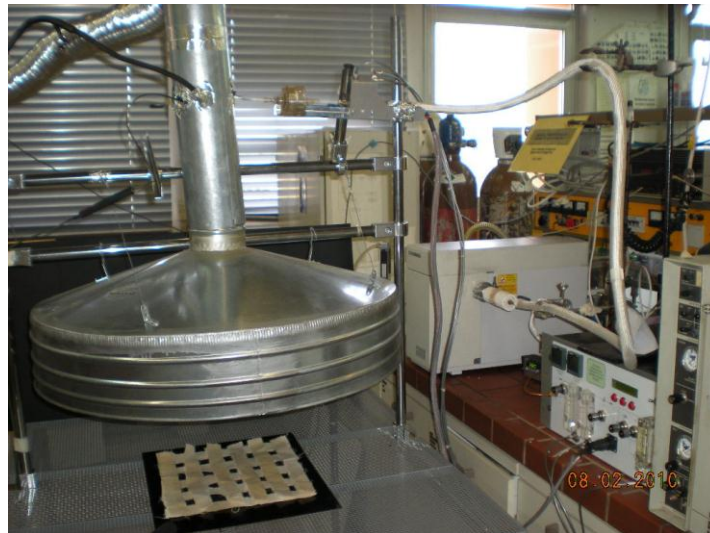
Εικόνα 32: Μερική όψη της πειραματικής διάταξης, όπου εμφανίζεται ο απαγωγός καυσαερίων, το καύσιμο υλικό και μέρος του PSS-MS καθώς και ο τριχοειδής δειγματοληπτικός σωλήνας του οργάνου
