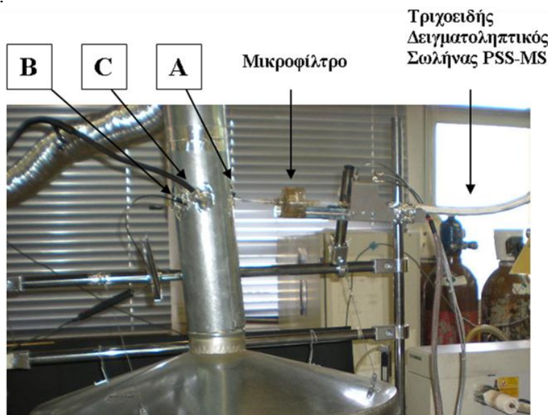
Εικόνα 35: Λεπτομέρειες επί της πειραματικής διάταξης (τα σημεία A, B και C είναι τα αυτά, ως εμφανίζονται στο διάγραμμα 1)
