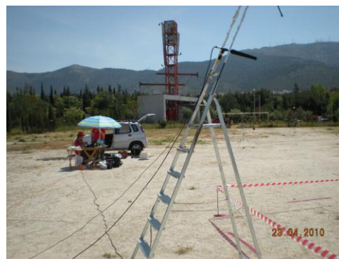
Εικόνα 64: (α) Ο φορητός ΗΥ συνδεδεμένος με την εξωτερική κάρτα ήχου στο πεδίο και (β) το μικρόφωνο τοποθετημένο σε ύψος περίπου 2,5 m συνδεδεμένο μέσω καλωδίου, μήκους 15
