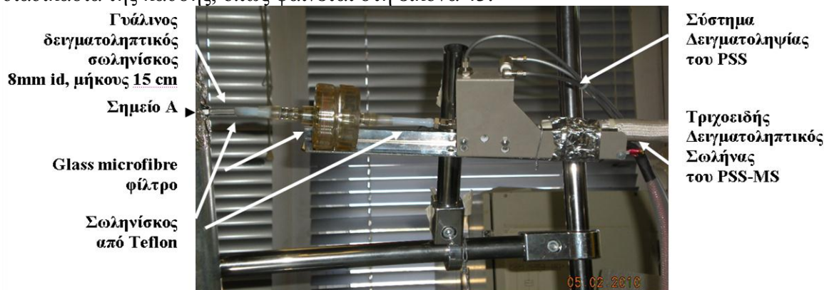
Εικόνα 43: Διάταξη δειγματοληψίας του PSS-MS επί του ικριώματος
