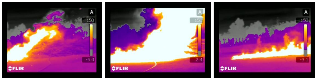
Εικόνα 66: Στιγμιότυπα που εξήχθησαν από το βίντεο της θερμογραφικής κάμερας FLIR T360 κατά την διάρκεια καύσης της δασικής ύλης στο ανοιχτό πεδίο και που αντιστοιχούν σε διαφορετικές στιγμές του πειράματος: (α) στιγμιότυπο Νο 7 ( 7 \times 5 = 35 sec ή 0,58 min του πειραματικού χρόνου), (β) στιγμιότυπο Νο 20 ( 20 \times 5 = 100 sec ή 1,67 min του πειραματικού χρόνου) και (γ) στιγμιότυπο Νο 70 ( 70 \times 5 = 350 sec ή 5,83 min του πειραματικού χρόνου).
