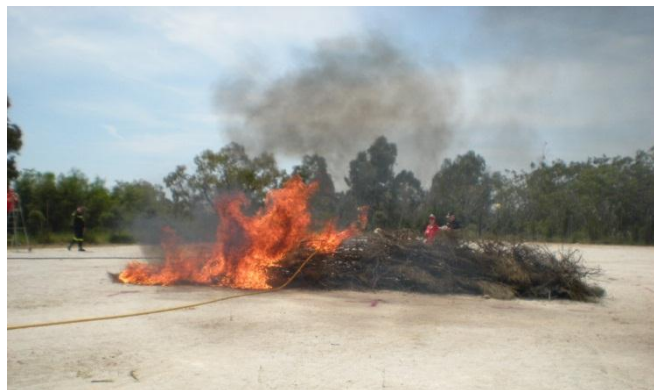
Εικόνα 60: Δοκιμή εύκαμπτου πυροσβεστικού σωλήνα, σε συνθήκες πεδίου
