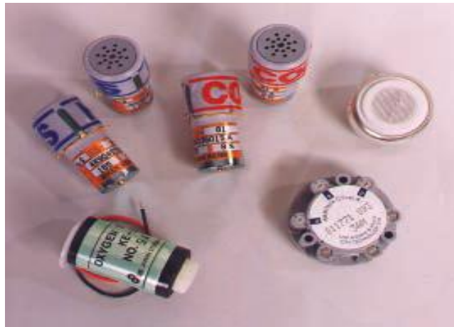
Εικόνα 11: Φορητοί ηλεκτροχημικοί αισθητήρες προσωπικής προστασίας (Πηγή: Jack Choo 2000)
