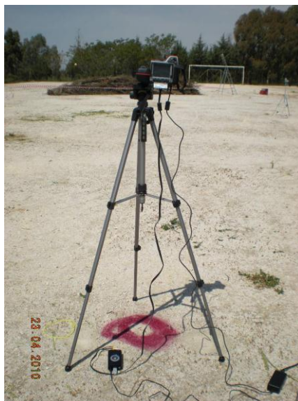
Εικόνα 65: Η φορητή θερμογραφική κάμερα FLIR T360 τοποθετημένη πάνω σε τρίποδο και συνδεδεμένη με την συσκευή Pinneacle video transfer. Η συσκευή αυτή κατέγραψε σε φορητό αποθηκευτικό μέσο (USB memory stick) το βίντεο που εξήχθη από την φορητή θερμογραφική κάμερα, μέσω της εξόδου AV από το πείραμα καύσης της δασικής ύλης στο ανοιχτό πεδίο.
