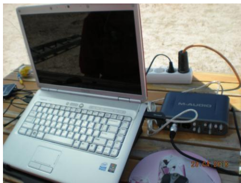
Εικόνα 64: (α) Ο φορητός ΗΥ συνδεδεμένος με την εξωτερική κάρτα ήχου στο πεδίο και (β) το μικρόφωνο τοποθετημένο σε ύψος περίπου 2,5 m συνδεδεμένο μέσω καλωδίου, μήκους 15
