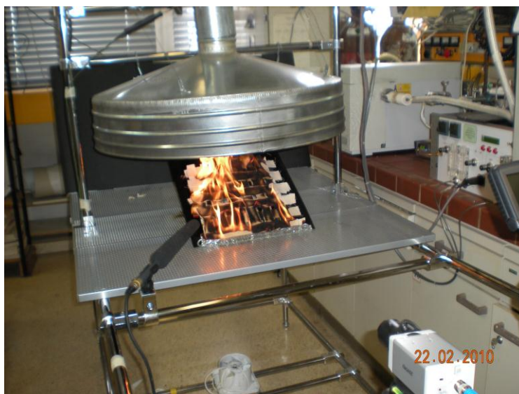
Εικόνα 53: Πειραματική διάταξη πειραμάτων καύσης τριών διαφορετικών υλικών, υπό κλίση και χωρίς την παρεμβολή εμποδίων.
