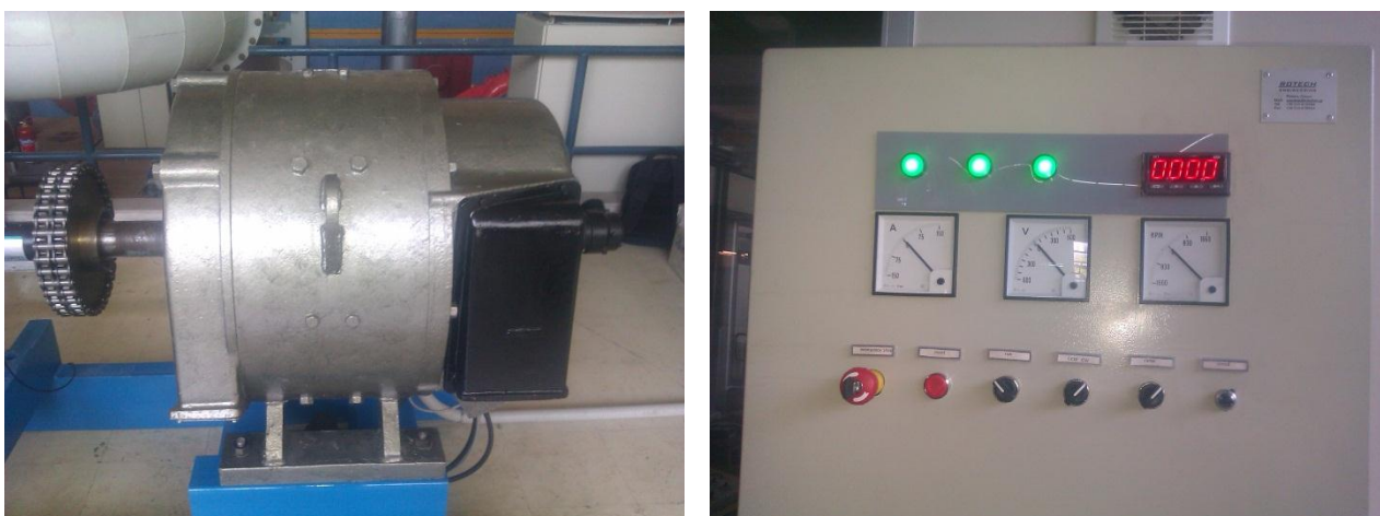
Σχήμα 7. 2: Ο DC κινητήρας και το σύστημα ελέγχου των στροφών του
