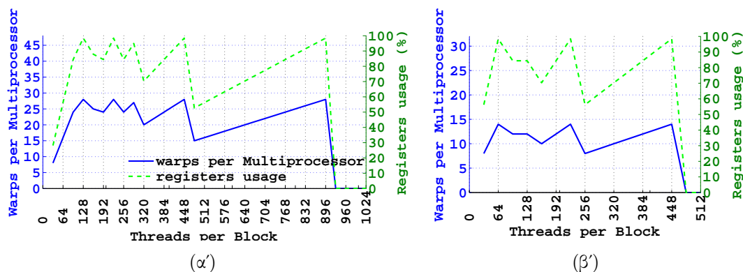
Σχήμα 3.12: Σύνολο των warps που εκτελούνται ανά πολυεπεξεργαστή μίας GPU αρχιτεκτονικής (α') Fermi ή (β') GT200 συναρτήσει του αριθμού των threads ανά block, για ένα kernel η εκτέλεση του οποίου απαιτεί 36 registers ανά thread. Φαίνεται, επίσης, το ποσοστό των διαθέσιμων registers που χρησιμοποιούνται ανά πολυεπεξεργαστή.
