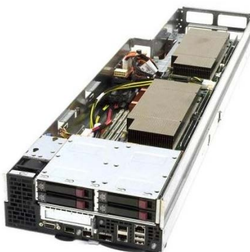
Σχήμα 1.5: Blade server της HP με τρεις ενσωματωμένες Tesla M2050. Στις αρχές του 2011, εγκαταστάθηκε στη ΜΠΥΡ&B/ΕΘΣ συστοιχία τεσσάρων τέτοιων διασυνδεδεμένων υπολογιστικών κόμβων.
