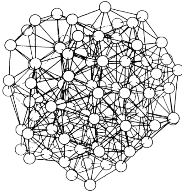
Σχήμα 1.4: Αναπαράσταση μέσω υπολογιστή δομής RCP 100 ατόμων. (1)
