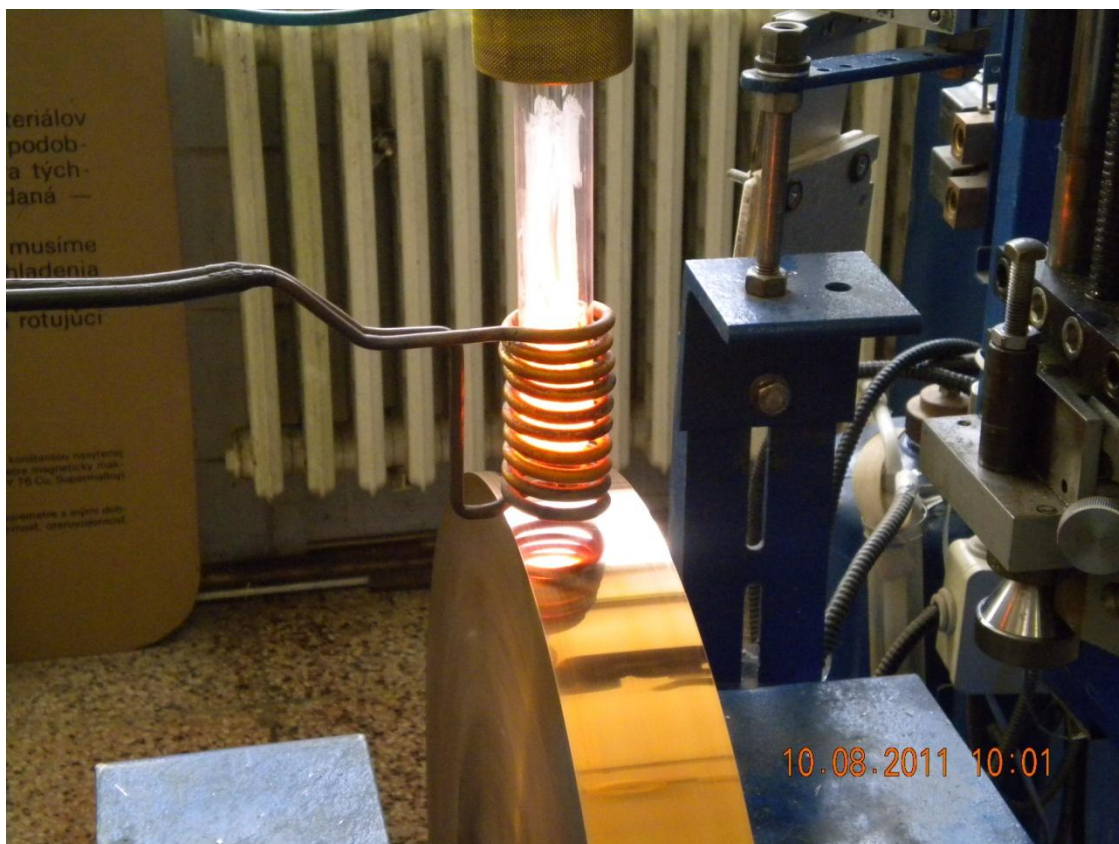
Σχήμα 4.2: Φωτογραφία όπου παρουσιάζεται τμήμα της διάταξης χύτευσης ταινίας που χρησιμοποιήθηκε.
