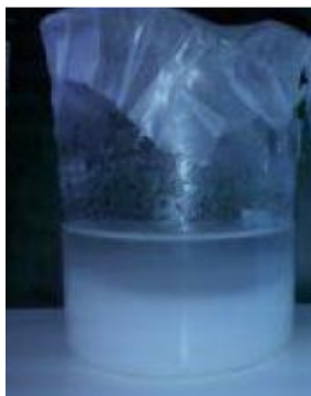
Εικόνα 28-Φωτογραφία τελικού αιωρήματος υδροξυαπατίτη που προέκυψε μετά από ικανοποιητική διάλυση του κολλαγόνου σε φωσφορικό οξύ.
