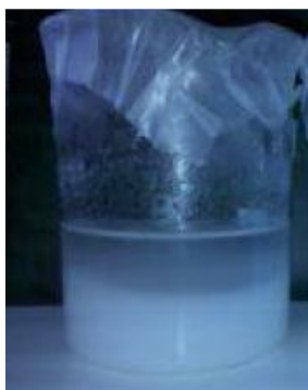
Εικόνα 12. Εικόνα οργανικού-ανόργανου κολλοειδούς αιωρήματος υδροξυαπατίτη-κολλαγόνου που παρήχθη στα πλαίσια της παρούσας εργασίας
