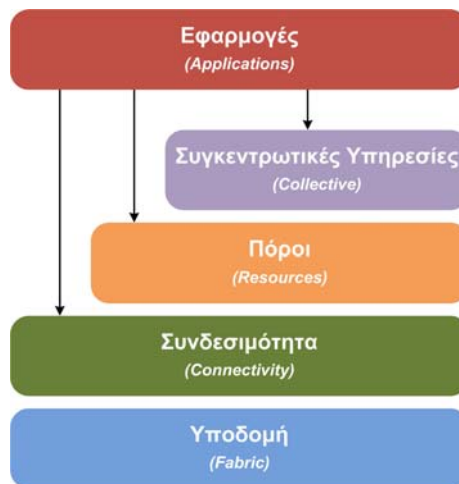
Σχήμα 2: Αρχιτεκτονική Πρωτοκόλλων Δικτύου Πλέγματος
