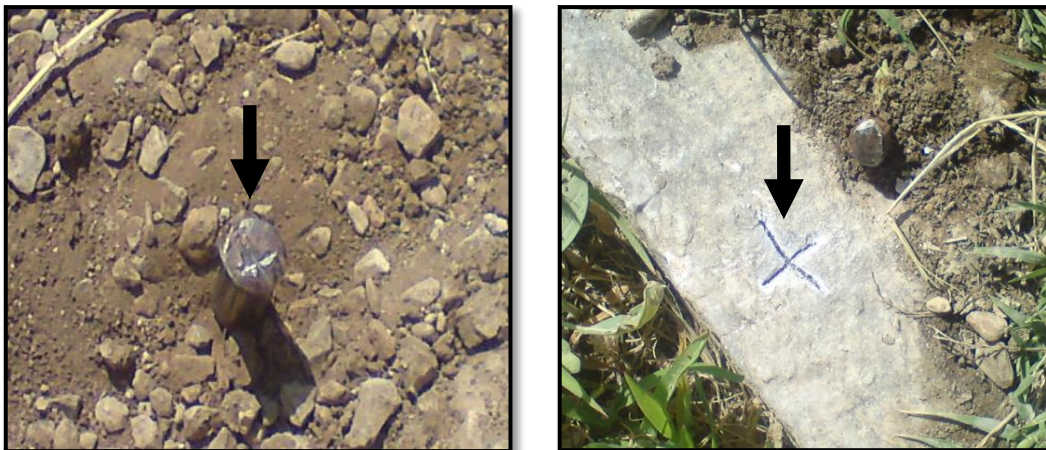
Εικόνα 14 & 15: Σήμανση με σιδερόβεργα & με χάραξη σταυρού
