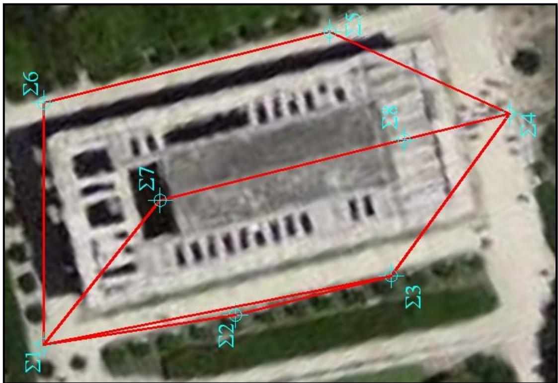
Εικόνα 20: Μορφή Δικτύου Οριζοντίου Ελέγχου [15] Picture 20: Shape of the Horizontal Control Network [15]
