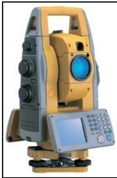
Εικόνα 17: Γεωδαιτικός Σταθμός Topcon IS 203i [18]
