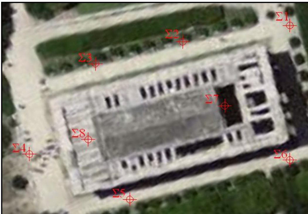
Εικόνα 13: Θέσεις κορυφών δικτύου οριζοντίου ελέγχου [15]
