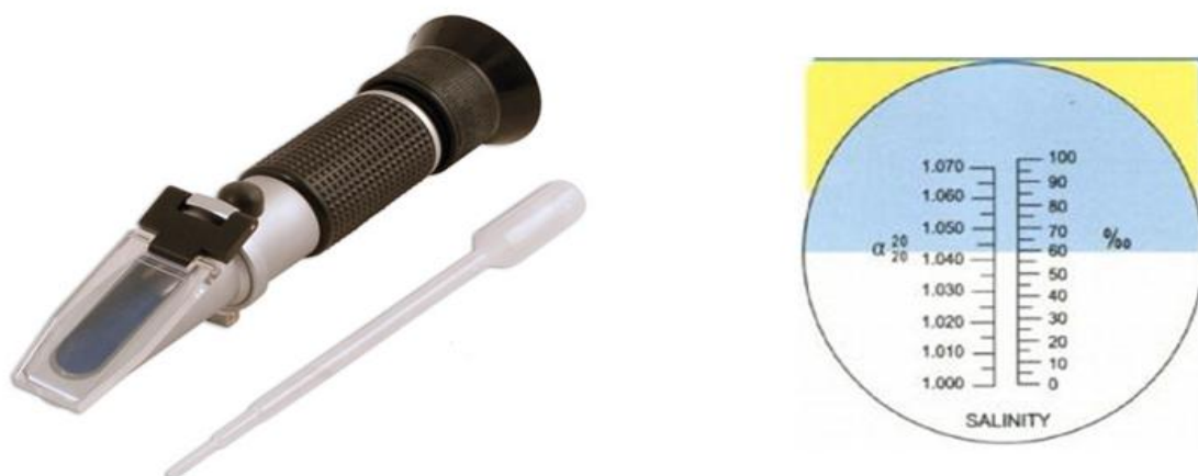
Σχήμα 2.9 Οπτικό διαθλασίμετρο (αριστερά) και πεδίου ανάγνωσης (δεξιά)
