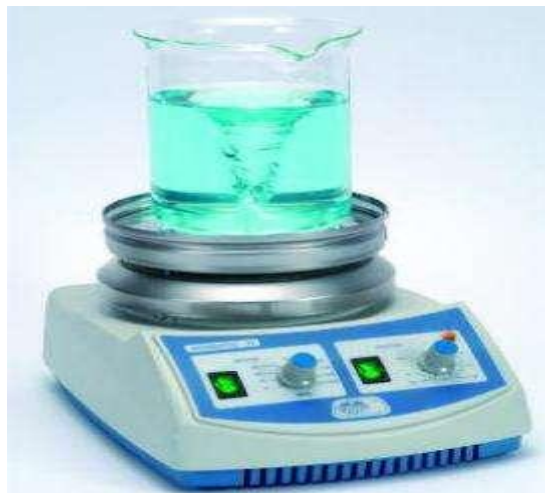
Σχήμα 2.7 Ανάδευση με μαγνητικό αναδευτήρα
