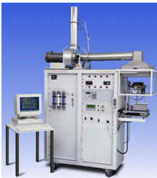
Εικόνα 10: Διάταξη κωνικού θερμιδομετρητή
