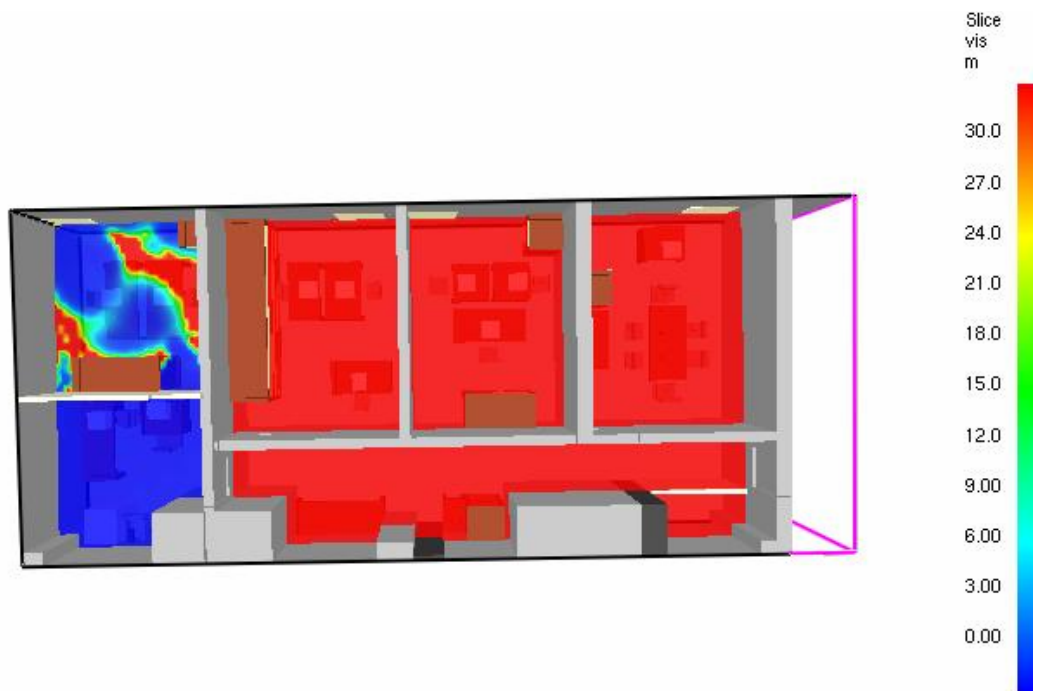
Εικόνα 135: Μετά από 8 s το δωμάτιο 1 έχει γεμίσει από καπνό και η ορατότητά του είναι 0
