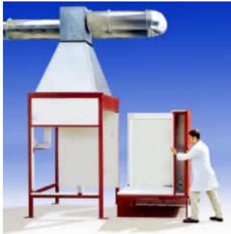
Εικόνα 7 : Εργαστηριακή διάταξη SBI Test
