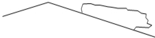
Εικόνα 4.6: Περίγραμμα του θερμοκρασιακού πεδίου των 25,5 \text{ }^\circ\text{C} για t = 339 \text{ sec} , Re = 120 , T_{\pi\lambda} = 36 \text{ }^\circ\text{C} , T_{\delta\epsilon\zeta} = 20 \text{ }^\circ\text{C} στο κατάντι τμήμα του ακροφυσίου
