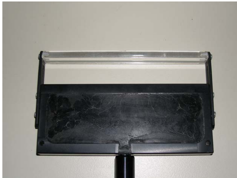
Εικόνα 3.8: Κεφαλή παραγωγής λευκού φύλλου φωτός και ημικυλινδρικός φακός
