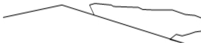
Εικόνα 4.8: Περίγραμμα του θερμοκρασιακού πεδίου των 25,5 \text{ }^\circ\text{C} για t = 11 \text{ sec} , Re = 120 , T_{\pi\lambda} = 36 \text{ }^\circ\text{C} , T_{\delta\epsilon\zeta} = 20 \text{ }^\circ\text{C} στο κατάντι τμήμα του ακροφυσίου
