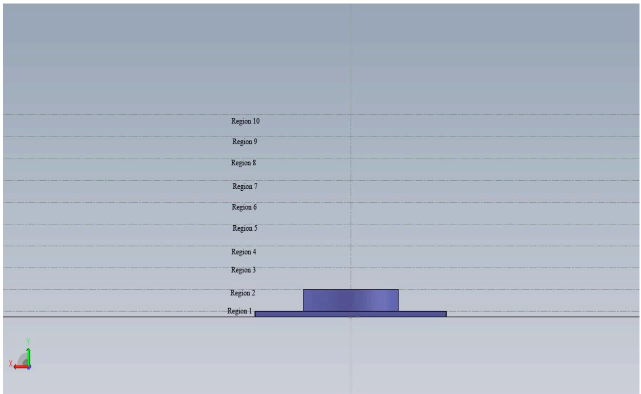
Εικόνα 16: Απεικόνιση της πρόοψης των δύο δεξαμενών καθώς και ο διαχωρισμός σε περιοχές (regions) ως προς το ύψος του πεδίου ροής.
