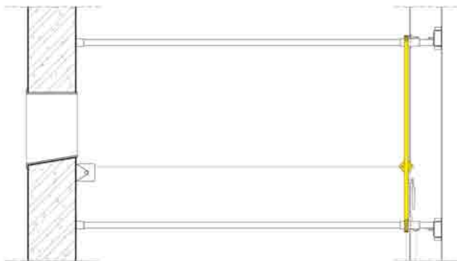
ΠΛΑΓΙΑ ΟΨΗ ΜΕΤΑΛΛΙΚΩΝ ΑΝΑΜΟΝΩΝ
