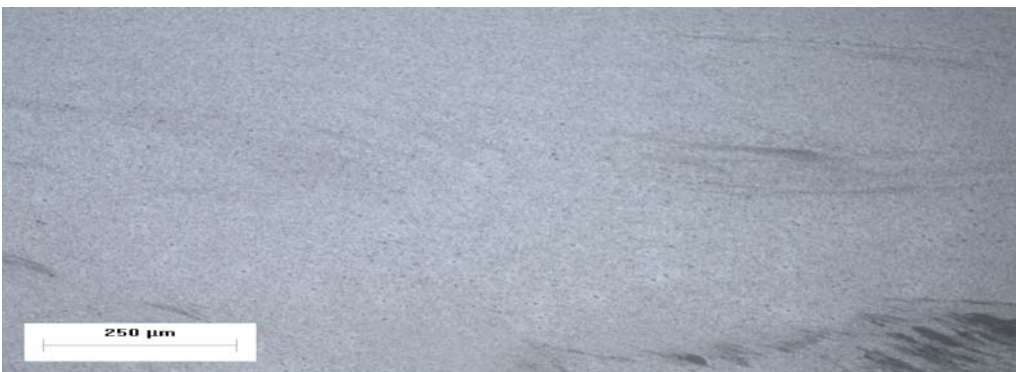
Σχήμα 7.33. (α) Εικόνα οπτικού στερεοσκοπίου της τομής του βέλτιστου δοκιμίου με σκόνη Al_2O_3 30nm μετά από ΡΡΗΤ. Εικόνες οπτικού μικροσκοπίου της σύνθετης ζώνης ανάδευσης του ίδιου δοκιμίου (β) κοντά στην επιφάνεια επαφής του περιανυχνίου με το τεμάχιο, και (γ) στο κέντρο της ζώνης ανάδευσης.
