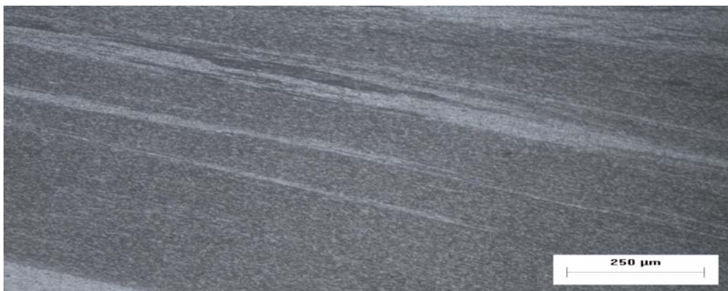
Σχήμα 7.31. (α) Εικόνα οπτικού στερεοσκοπίου της τομής του βέλτιστου δοκιμίου με σκόνη \text{Al}_2\text{O}_3 2\mu\text{m} μετά από ΡΡΗΤ. Εικόνες οπτικού μικροσκοπίου της σύνθετης ζώνης ανάδευσης του ίδιου δοκιμίου (β) κοντά στην επιφάνεια επαφής του περιαιχενίου με το τεμάχιο, και (γ) στο κέντρο της ζώνης ανάδευσης.
