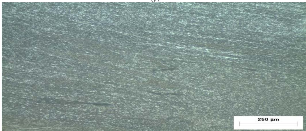
Σχήμα 7.20. (α) Εικόνα οπτικού στερεοσκοπίου της τομής του δοκιμίου που παρήχθη με προσθήκη 11,5% σκόνης Al_2O_3 30nm μέσω της FSP. Εικόνες οπτικού μικροσκοπίου της σύνθετης ζώνης ανάδευσης του ίδιου δοκιμίου (β) κοντά στην επιφάνεια επαφής του περιανυχνίου με το τεμάχιο, και (γ) στο κέντρο της ζώνης ανάδευσης.
