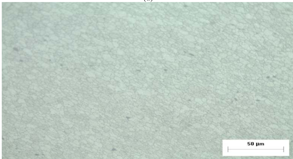
Σχήμα 7.7. Εικόνες οπτικού μικροσκοπίου της ζώνης ανάδευσης των δοκιμίων που παρήχθησαν μέσω της FSP με ταχύτητες περιστροφής: (α) 950rpm και (β) 1180rpm.
