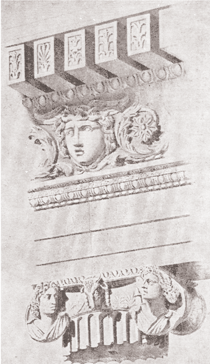
Εικ. 10 : Ναός του Διδυμαίου Απόλλωνα. Αναπαράσταση κιονόκρανου και του θριγκού, κατά Pontremoli
