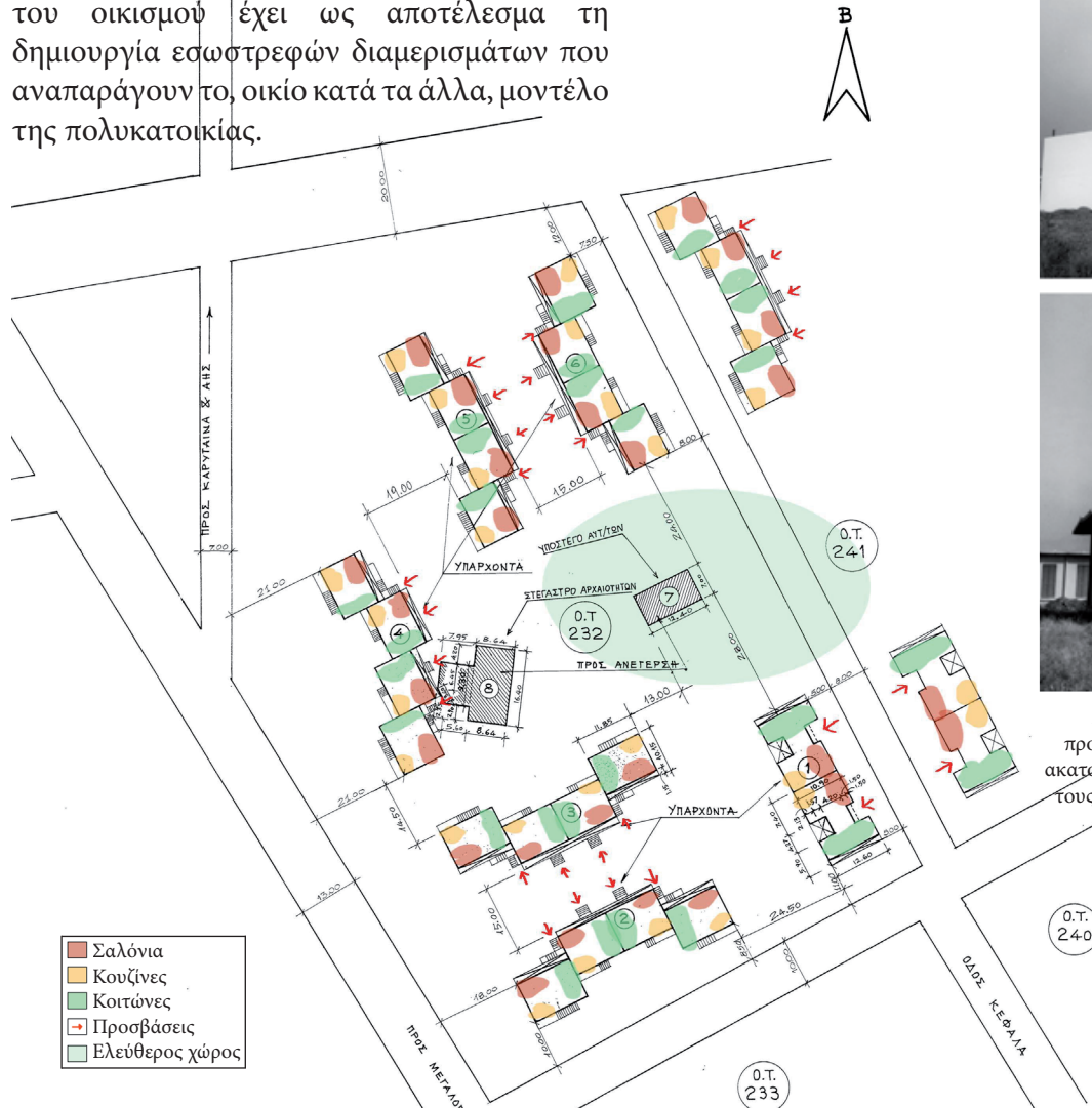
Εικ. 53 Διαγραμματική απεικόνιση των προσβάσεων και της διάταξης των εσωτερικών χώρων των κατοικιών κατηγορίας I και II. (τμήμα σχεδίου)
