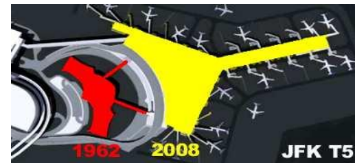
Η αίθουσα αναμονής του Eero Saarinen και το σχέδιο προέκτασης του σταθμού
