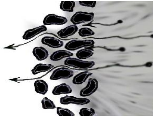
Σχήμα 2.3: Κίνηση του υλικού του πυρήνα μέσα από το φίλτρο σε περίπτωση διάβρωσης (Πηγή: S. Shahab Yasrobi και Ali Azad, Tarbiat Modares University )
