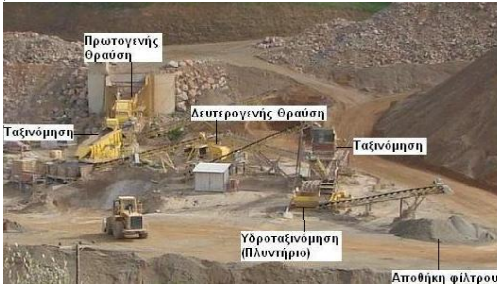
Σχήμα 3.1: Διαδικασία παραγωγής του λεπτόκοκκου φίλτρου. (Πηγή: Σωμάκος Λάμπρος, 2011)
