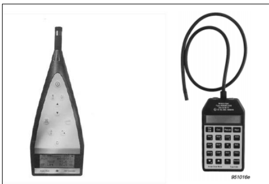
Εικόνα 4-6: ηχόμετρο Sound Level Meter 2238 Mediator BRUEL & KJAER (αριστερά), ηχοδοσίμετρο Noise Dose Meter 4436, BRUEL & KJAER (δεξιά)
