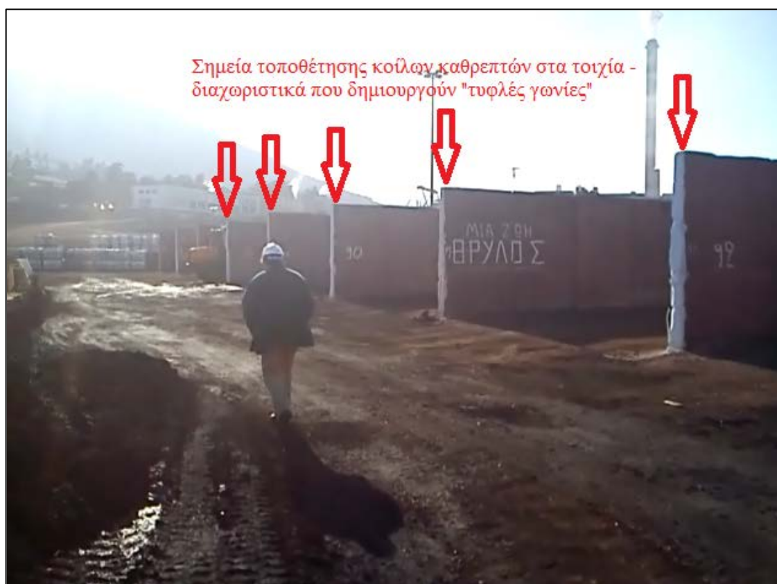
Εικόνα 4-12: Χώροι αποθήκευσης έτοιμου προϊόντος (Τοποθέτηση κοίλων καθρεπτών σε "τυφλές γωνίες")
