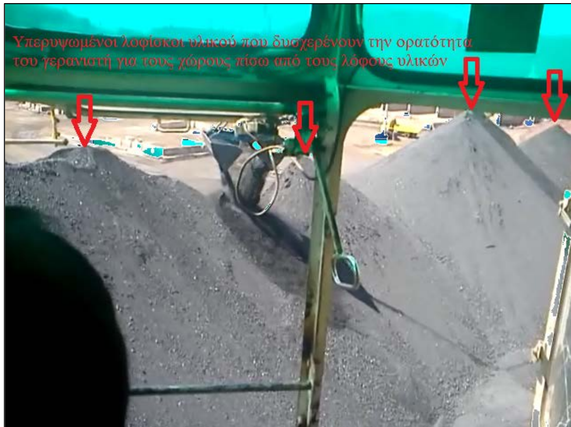
Εικόνα 4-10: Υπερυψωμένοι λόφοι υλικών δίπλα από τους χώρους των γερανών
