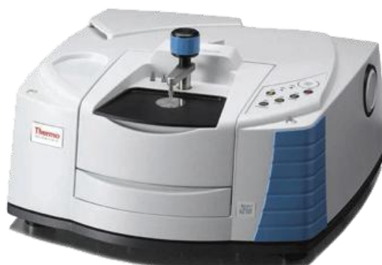
Εικόνα 5.4. Φασματόμετρο υπέρυθρου μετασχηματισμού Fourier, Nicolet 6700 thermoscientific, διακριτικής ικανότητας 4\text{ cm}^{-1} .
